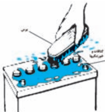
الف- شستن بدنه باتری با آب و برس
