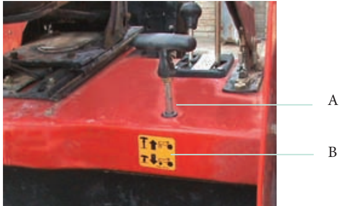
A: اهرم کنترل دیفرانسیل جلو ، B: نمایه حرکت دسته کنترل دیفرانسیل جلو
