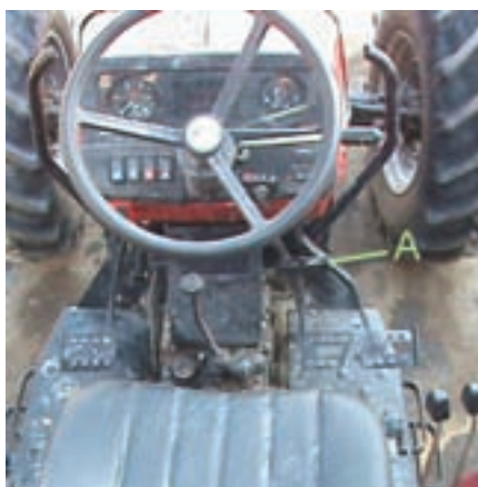
شکل ۲-۲ جفت کن پدال ترمز در تراکتور MF399
