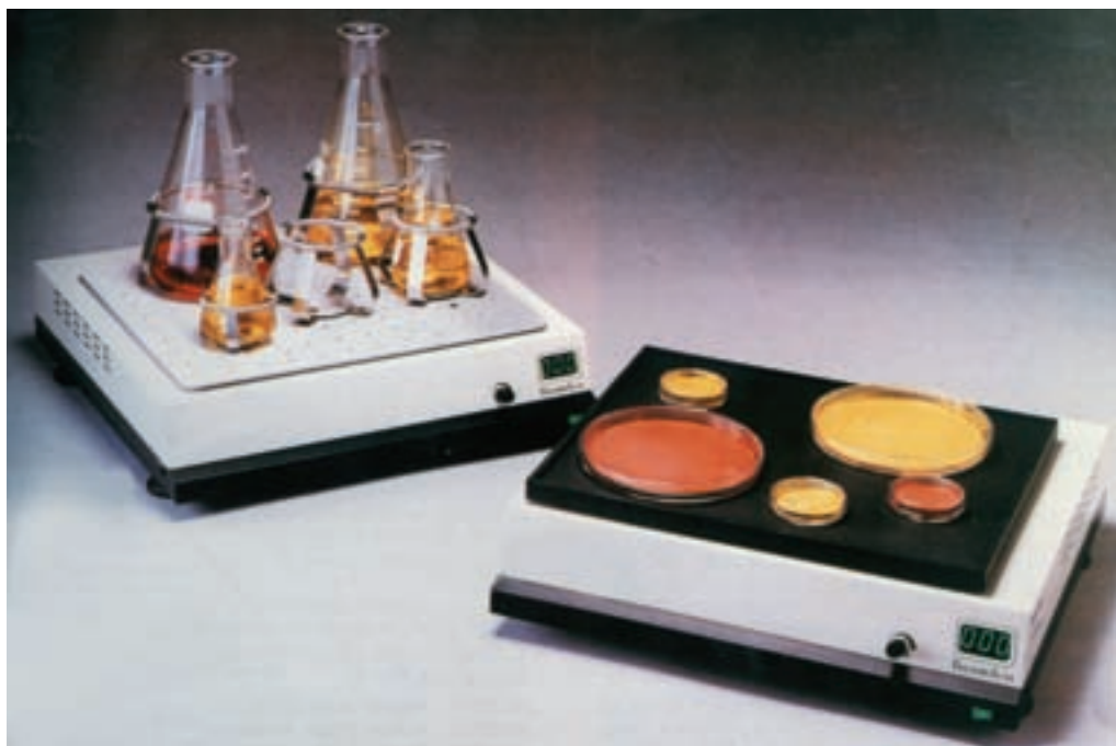
شکل ۸-۲- نمونه‌ای از شیکر مخصوص پتری دیش و ارلن آزمایشگاهی
