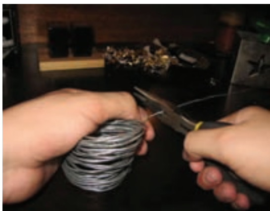
تصویر ۱-۷۷ طرز کاربرد سیم چین، دم باریک
