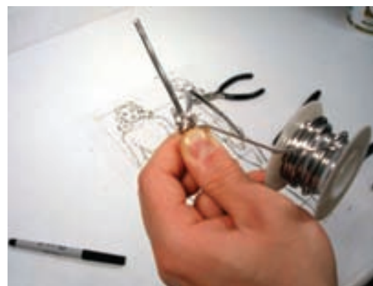
تصویر ۱-۷۸ نحوه ی ایجاد حلقه ها جهت تولید فرم یا گره، سیم
