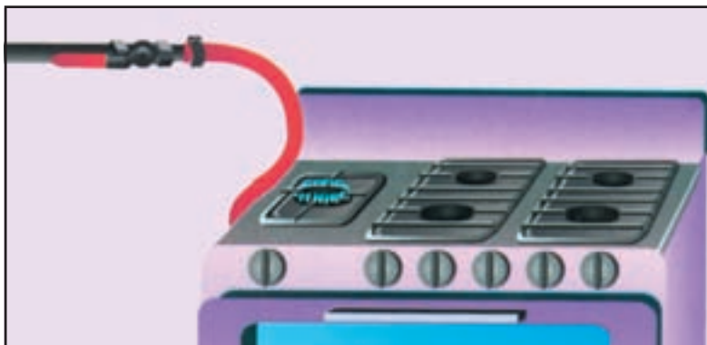
شکل ۸-۶- هنگام روشن کردن گاز، اول شیر فلکه اصلی گاز را باز کرده، سپس کبریت را روشن کنید و آنگاه شیر یا کلید خود اجاق گاز را باز نمایید.
