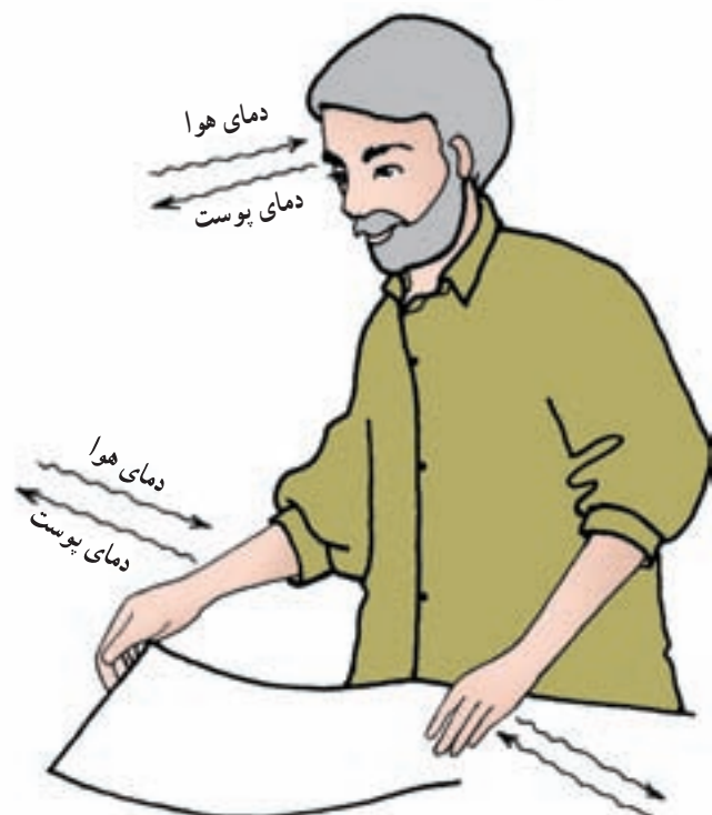
شکل ۱۳-۳- انتقال گرما از راه جابجایی
