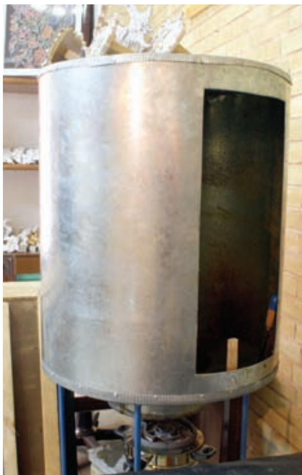
شکل ۹-۱۵- ب - منبع حرارتی و مخزن روغن کلاقه‌ای
