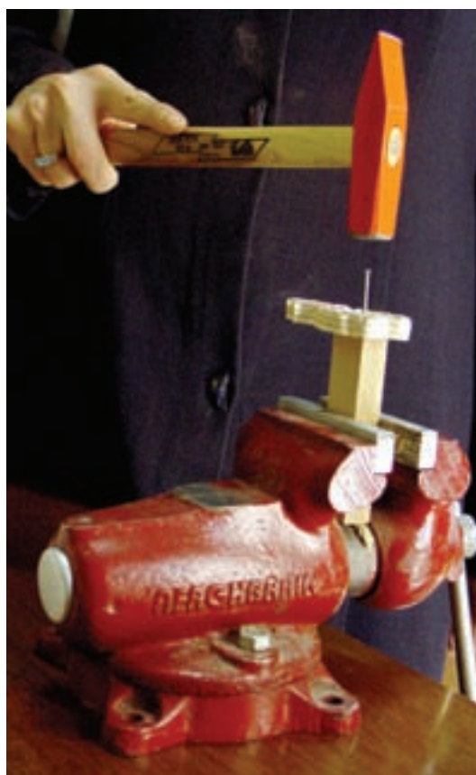
شکل ۱۸-۹- ب - اتصال سر قالب به دسته
