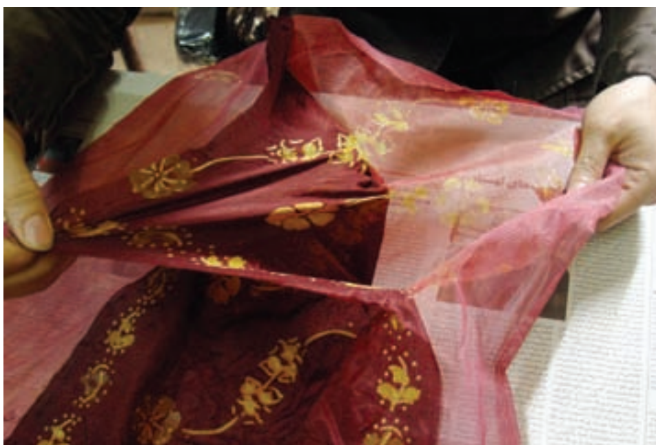
شکل ۲۱-۹- مراحل اتوکردن و زدودن ماده‌ی مقاوم از پارچه
