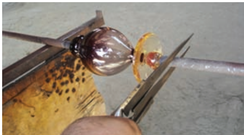
شکل ۷-۱۲- چسباندن میله‌ی واگیره به انتهای شیء ساخته شده و جداساختن لوله‌ی دم اولیه از سر شیء
