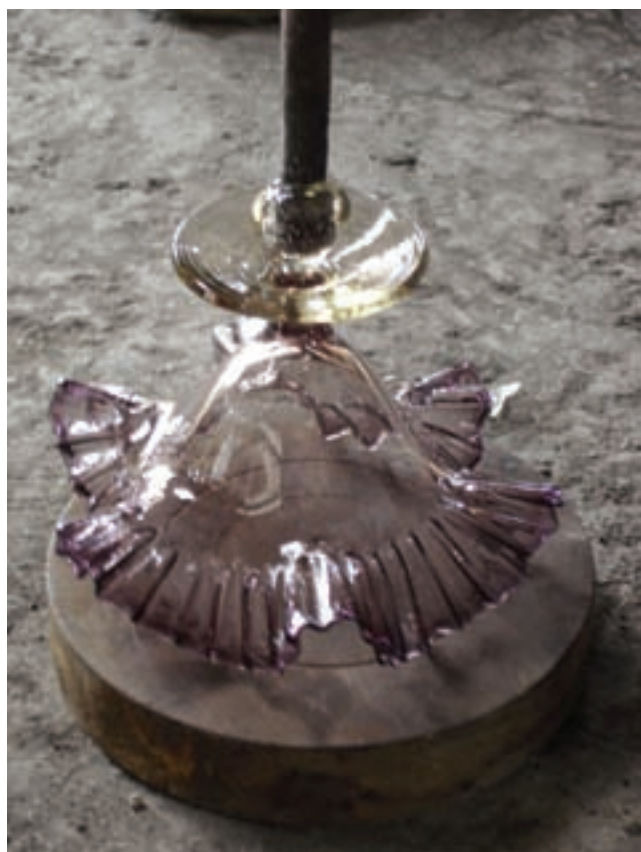
شکل ۷-۱۵- شکل دهی دهانه ی شیء با قالب پرسی (فشاری)
