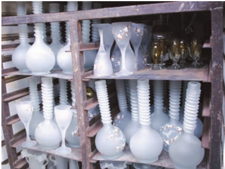
شکل ۲۴-۷ - چیدن اشیای نقاشی شده درون کوره برای پختن لعاب‌های رنگی
