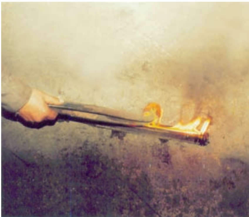
شکل ۱۱-۶- الف- تهیه‌ی مذاب نقره
