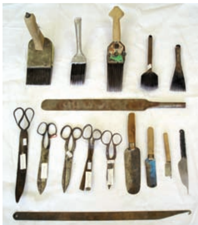
شکل ۱۳-۵ ب- ابزار و وسایل بافندگی داری
