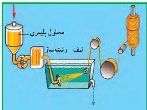
شکل ۱۱-۶- مراحل تولید نخ یک‌سره با روش ترریسی
