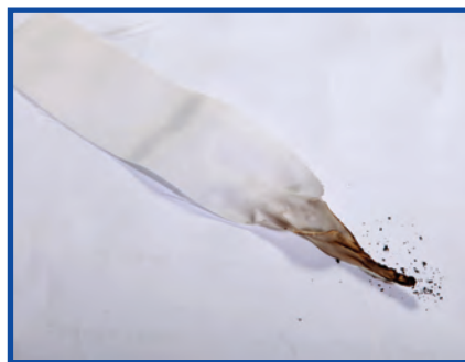
شکل ۹-۴ خاکستر حاصل از سوختن پارچه استات
