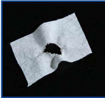
شکل ۴-۵ اثر اسید کلریدریک بر پارچه ویسکوز ریون
