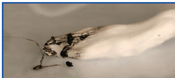
شکل ۵-۱۴- خاکستر حاصل از سوختن الیاف اکریلیک
