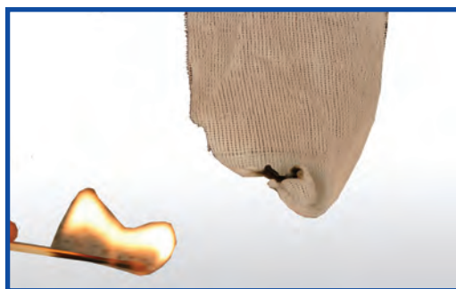
شکل ۵-۸ - سوختن پارچه از جنس پلی استر
