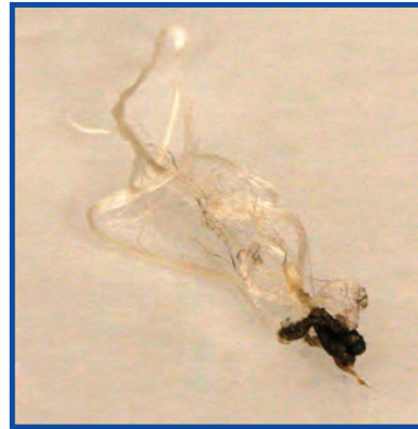
شکل ۵-۳- خاکستر حاصل از سوختن نخ نایلونی
