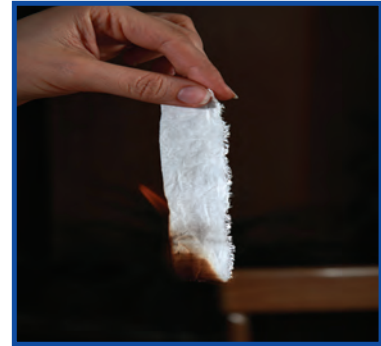
شکل ۴-۳ سوختن پارچه ویسکوز ریون
