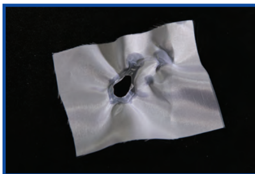
شکل ۱۰-۴ اثر استن بر پارچه استات
