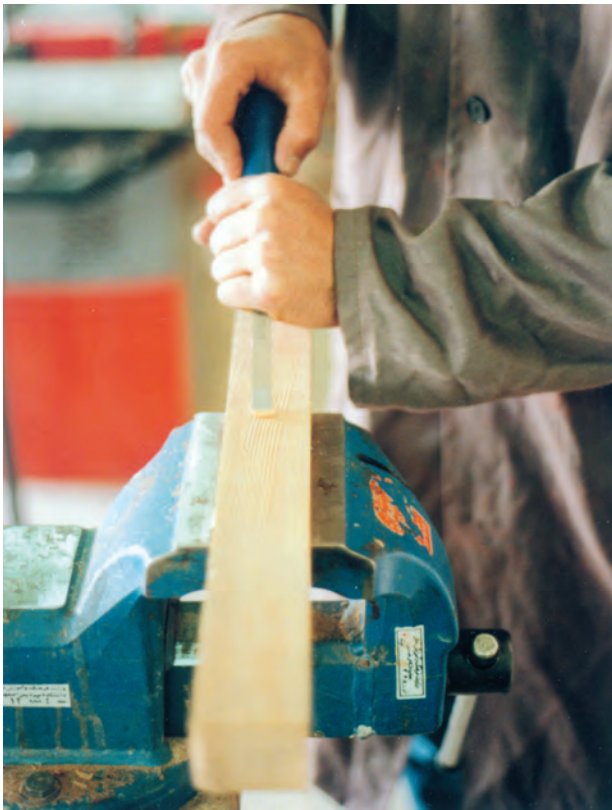
تصویر ۱-۱-۳- یک نمونه از نحوه مهار نمودن قطعه چوب مورد کنده کاری به وسیله گیره طرز صحیح گرفتن مغار با دو دست (یک دست دسته مغار، یک دست وسط تیغه مغار)
