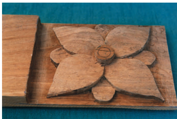
تصویر ۴-۱۲-۳ تمام گلبرگها از قسمت سر و انتها به سمت زمینه تراش خورده و انحنا پیدا می نماید. قسمت انتهایی گلبرگچه ها نیز به سمت پایین تراش می خورد.
