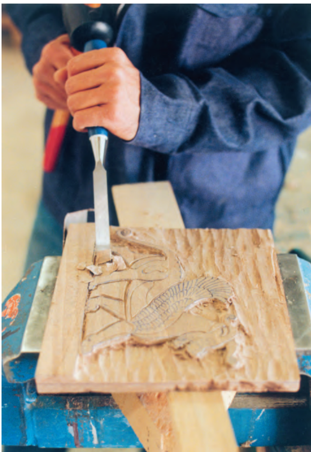
تصویر ۳-۱۵-۹- کندن زمینه به وسیله مغار تخت
