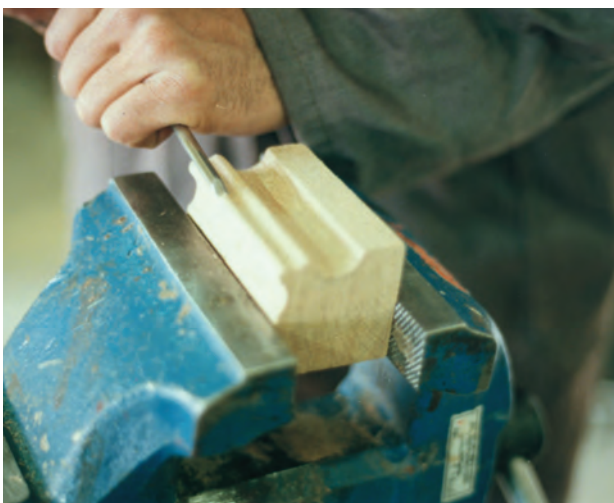
تصویر ۶-۱۰-۳- نمونه دیگری از تراش کانالهای ناودانی به وسیله مغار گلوبی بسته
