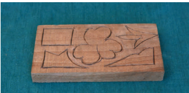
تصویر ۳-۹-۷- بعد از دورگیری اشکال ساده
