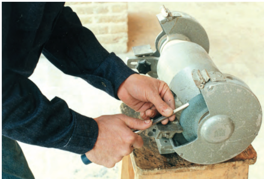
تصویر ۱-۶-۳ روش شکل دادن زاویه لبه برش و شیب نوک با دستگاه سنگ دوآر
