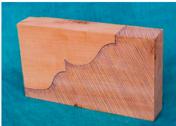
تصویر ۲-۱۲-۳- شکل مورد نظر به روی قطعه چوب ترسیم شده است (قسمت مورد نظر پرداز خورده و قسمت پرداز نخورده به وسیله مغار تراش می‌خورد).
