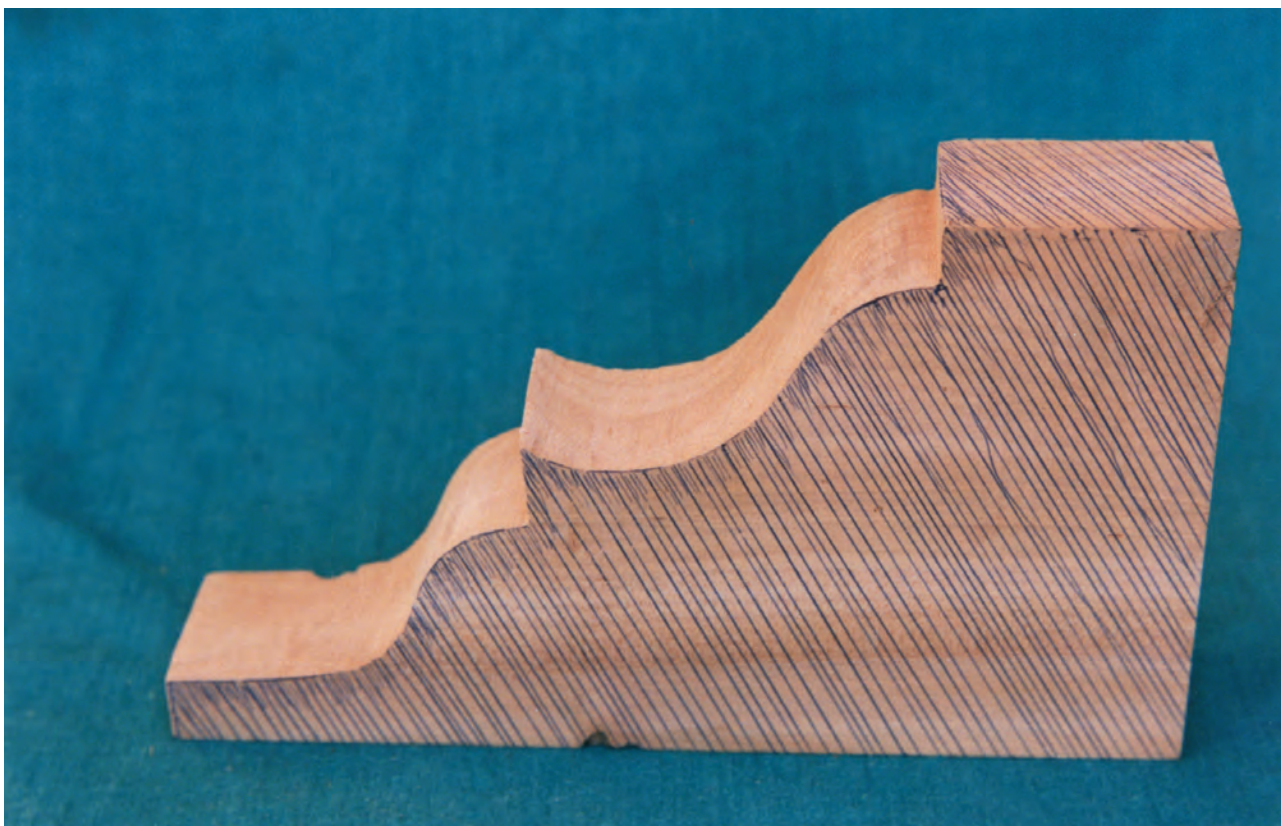
تصویر ۳-۱۲-۳ حجم نهایی تراش خورده به وسیله مغار
