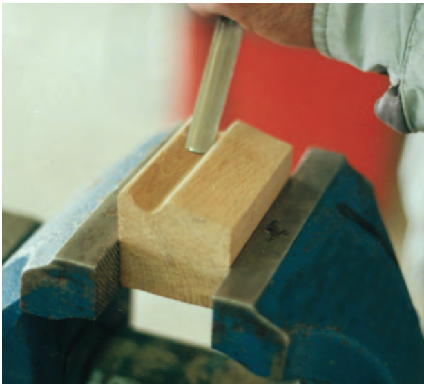
تصویر ۴-۱۰-۳- یک نمونه تراش کانالهای ناودانی روی یک قطعه چوب به وسیله مغار گلوبی باز
