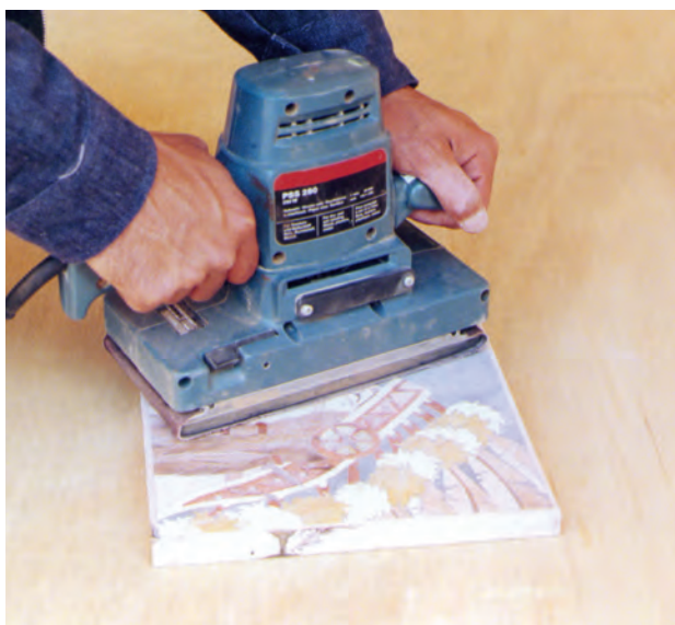
تصویر ۳-۱۳-۲- پرداخت یک تابلوی معرّق با دستگاه سمباده لرزان
