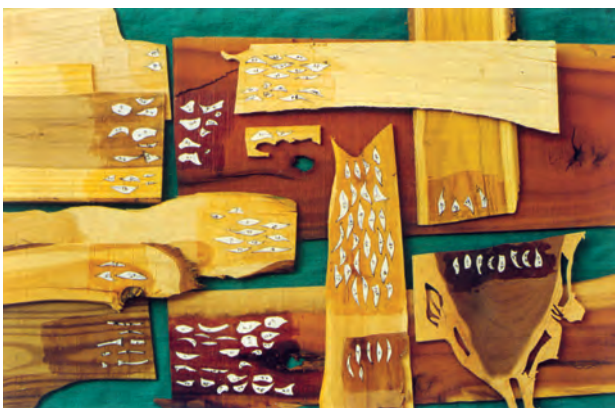
تصویر ۵-۱۱-۲- الگوهای به دست آمده بر اساس رنگ‌بندی مورد نظر به روی لایه‌های چوبی چسبانده می‌شود.
