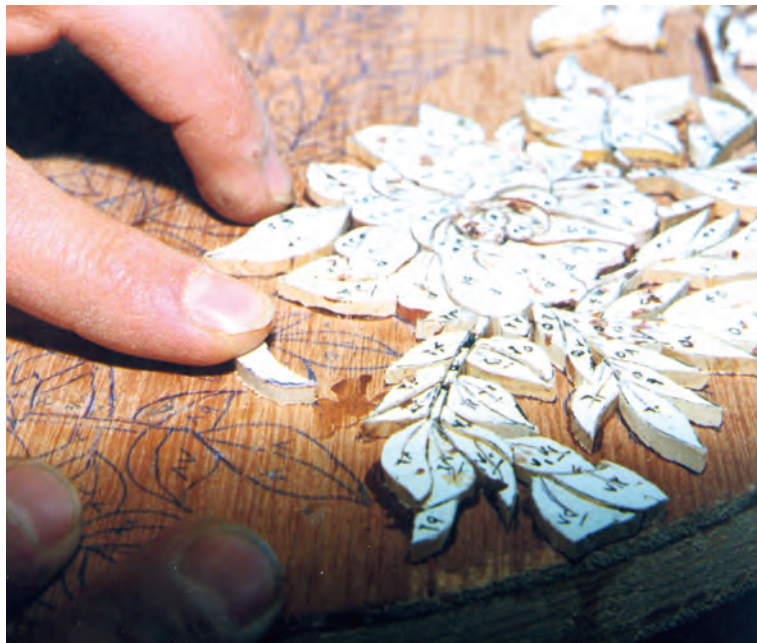
تصویر ۶-۱۱-۲- هر یک از قطعات بریده شده ابتدا در محل خود، روی زیر ساخت قرار می‌گیرد تا در مورد دقت برش آن اطمینان حاصل شود.
