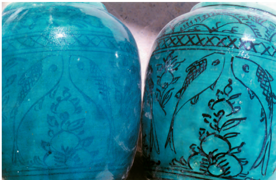
تصویر ۵- مقایسه دو بدنه لعابدار که یکی به‌علت نرسیدن به دمای پخت «مات» به نظر می‌رسد.
