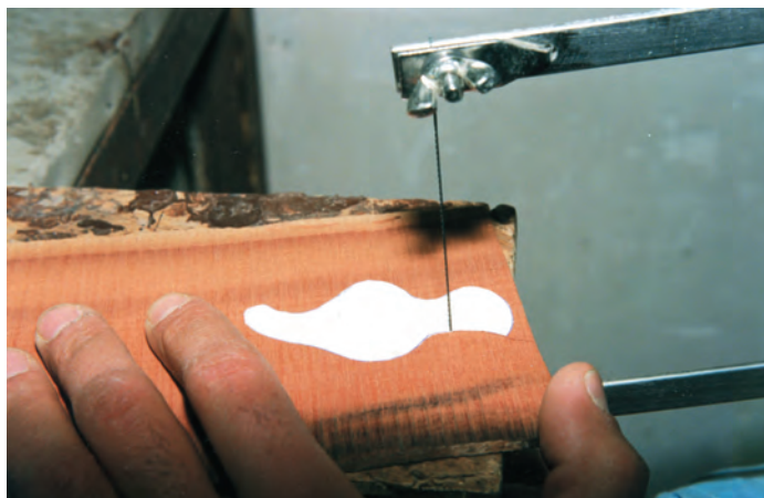
تصویر ۴- ۱۰- ۲- نحوه برش لایه چوبی بر اساس الگوی کاغذی. چنانچه ملاحظه می شود تیغه کماناره مماس به لبه کاغذ برش می دهد.
