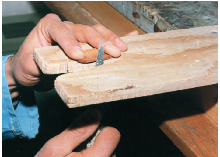
تصویر ۹-۱۰-۲- قطعاتی که دقیق برش نخورده اند سوهان کاری می شوند. نحوه سوهان کاری کناره قطعات بریده شده
