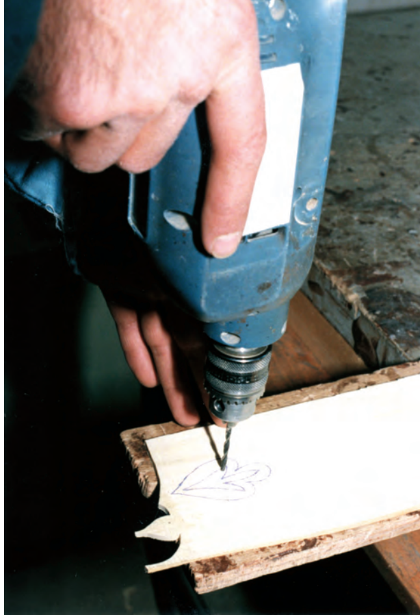
تصویر ۱۷ - ۸ - ۲ - سوراخ نمودن قسمت داخلی شکل به وسیله دریل
