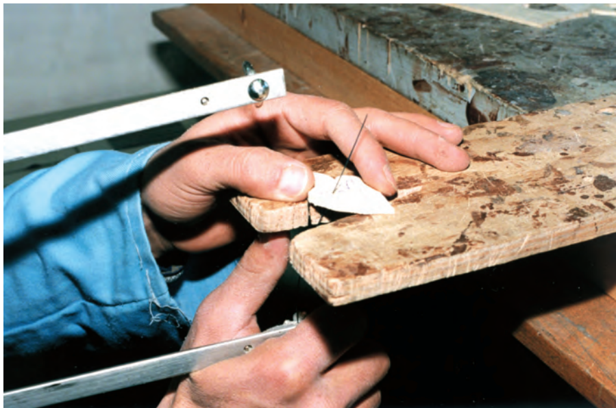
تصویر ۱۸ - ۸ - ۲ - بعد از برش خط بیرونی شکل و سوراخ نمودن آن لازم است یک سر تیغ‌اره از سوراخ رد شده و دوباره به پیچ کمان‌اره بسته شود.
