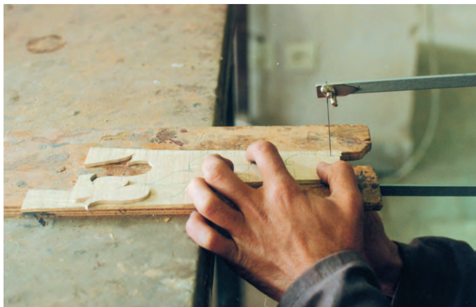
تصویر ۸-۸-۲ - چگونگی برش شکل‌های ساده
