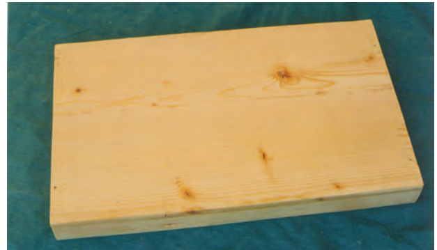
تصویر ۱-۶-۲- یک نمونه زیرساخت تخته‌ای تابلو به شکل مستطیل در صورتی که عرض تخته به اندازه موردنظر نبود می‌توان چند تخته هم طول را از پهلو بهم چسباند ۱ (تصویر ۲-۶-۲).
