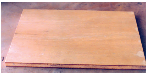
تصویر ۵-۶-۲- زیرساخت تخته لایه‌ای تابلو دو رو سه لایه پرس شده به شکل مربع
