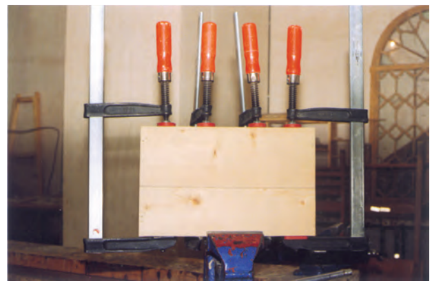
تصویر ۲-۶-۲- نحوه درز کردن دو تخته از پهلو برای دستیابی به زیرساخت بزرگتر
