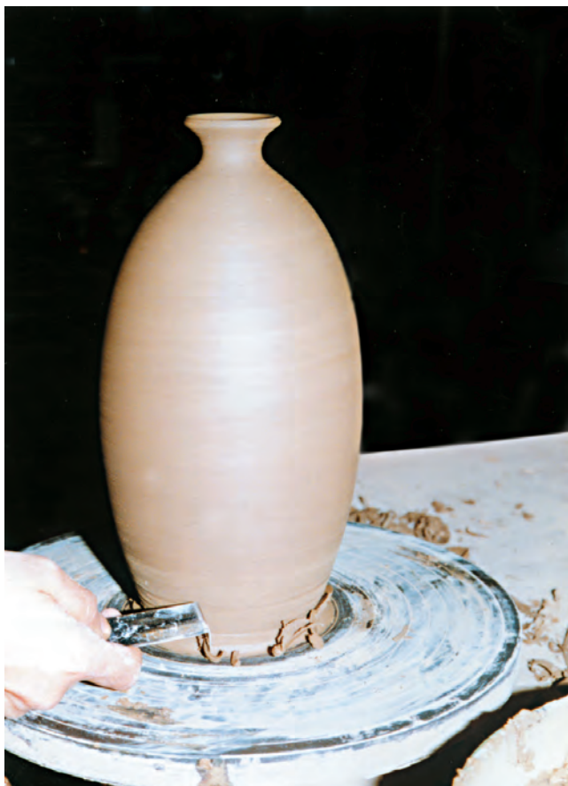
تصویر ۶۱ - تراشیدن محل تماس ظرف و سرچرخ برای برداشتن آن
