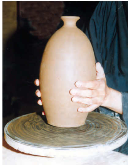
تصویر ۵۴ - قراردادن ظرف روی مرکز سرچرخ
