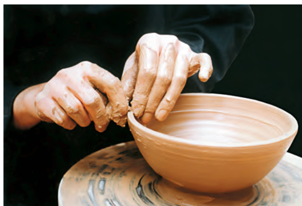
تصویر ۲۴- از بین بردن زوایای لبه کاسه
