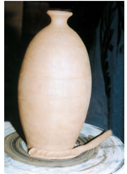
تصویر ۵۵ - قراردادن فتیله گل در محل تماس ظرف و سرچرخ
