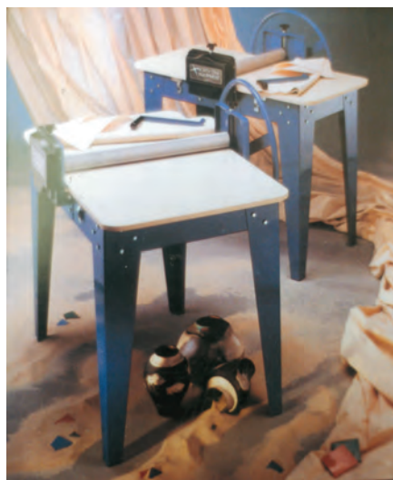
تصویر ۵- نوع دیگری از دستگاه غلتکی لوحه‌سازی ثابت
