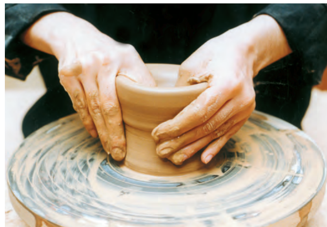
تصویرهای ۱۴ و ۱۵- گشاد کردن دهانه استوانه
