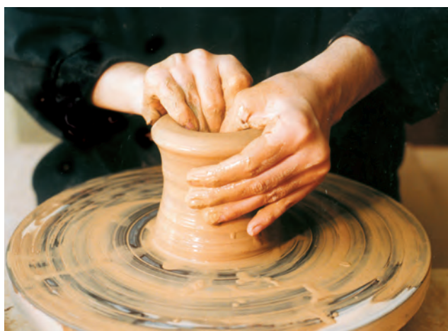
تصویرهای ۱۴ و ۱۵- گشاد کردن دهانه استوانه
