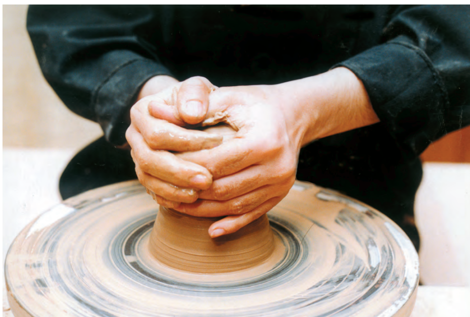
تصویر ۱۲- مسطح کردن سطح فوقانی استوانه توپُر
