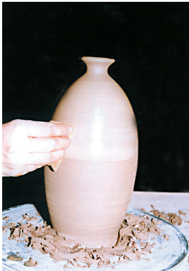
تصویر ۶۰ - صاف کردن سطح بدنه با اسفنج
