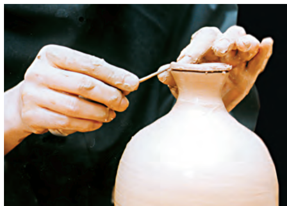
تصویر ۴۶- بریدن لبه کوزه با ابزار برش
