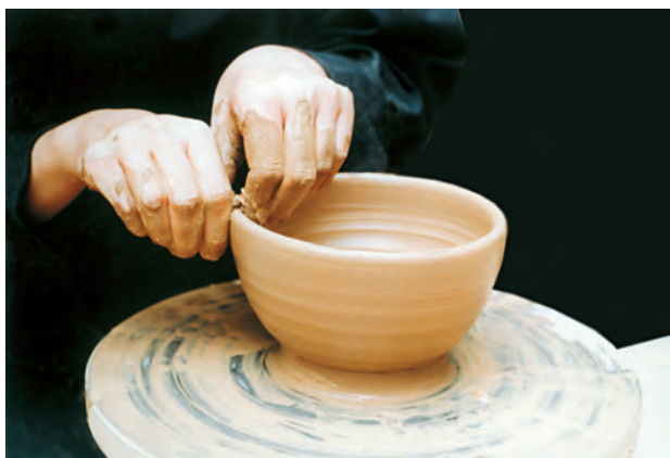
تصویر ۲۷- یکنواخت کردن لبه کاسه
