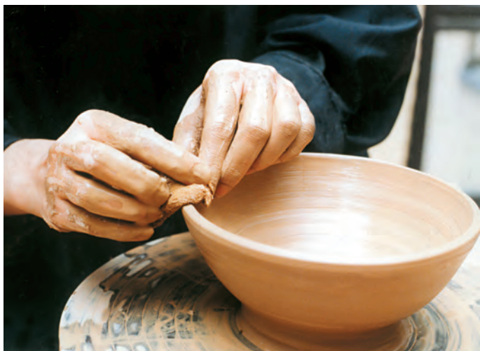
تصویر ۳۰- گرفتن دوغاب اضافه از سطح کاسه و یکنواخت کردن آن
