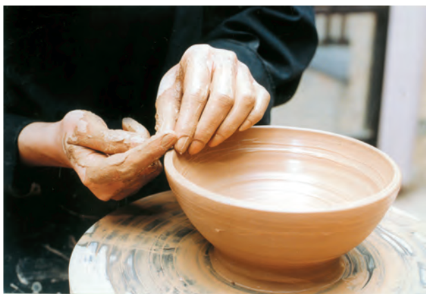
تصویر ۲۵- صاف کردن لبه لبه بریده شده
