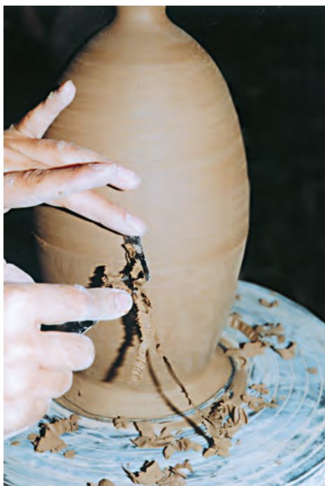
تصویر ۵۹ - تراشیدن قسمت‌های ضخیم بدنه
