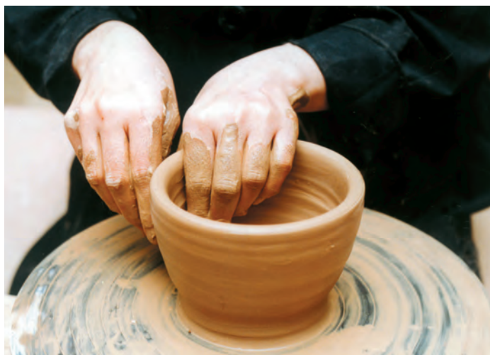
تصویر ۳۴ - قلاج کردن دیواره
