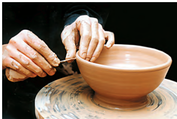
تصویر ۲۲- بریدن لبه کاسه با ابزار برش
