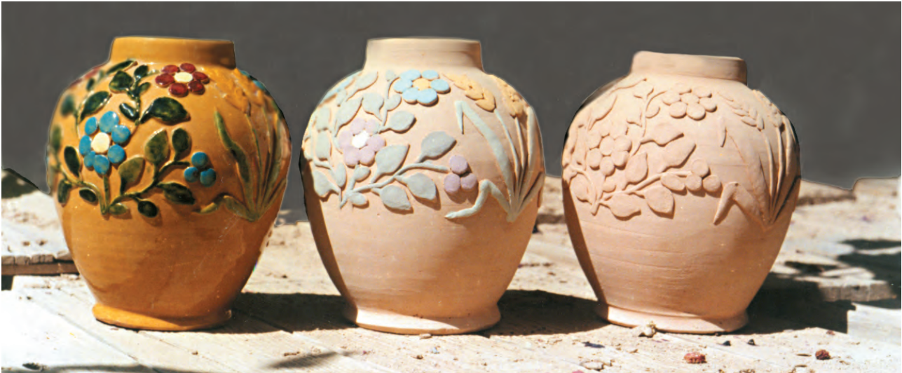
تصویر ۳- مراحل تزئین بدنه به روش نقش افزوده - کارگاه سفالگری سهیلی در شهرضا
