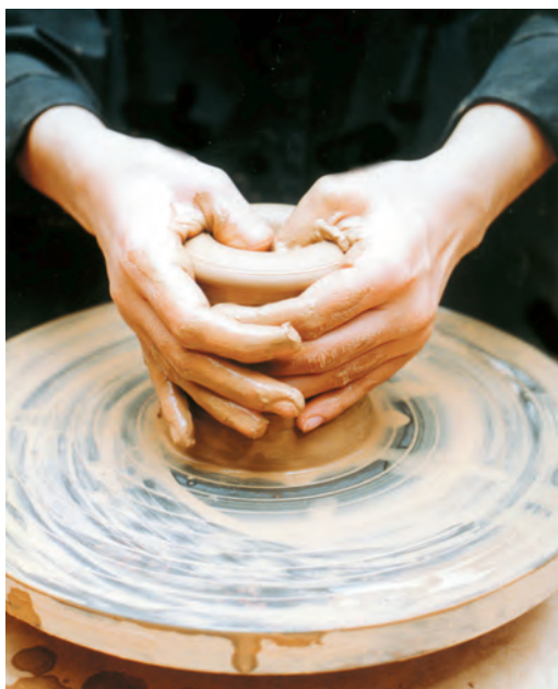
تصویر ۱۳- مراحل بازکردن استوانه توپر
