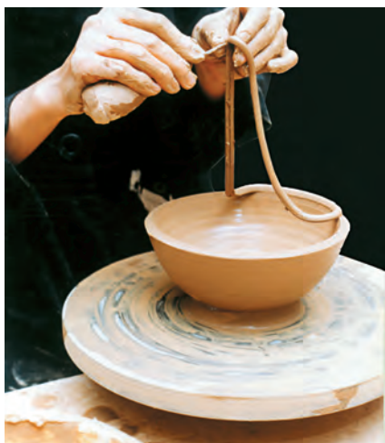
تصویر ۲۳- جدا کردن لبه لبه بریده شده
