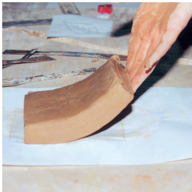
تصویر ۱- الف - مقدار رطوبت لوح زیاد است و هنگام بلند کردن خم می‌شود.
