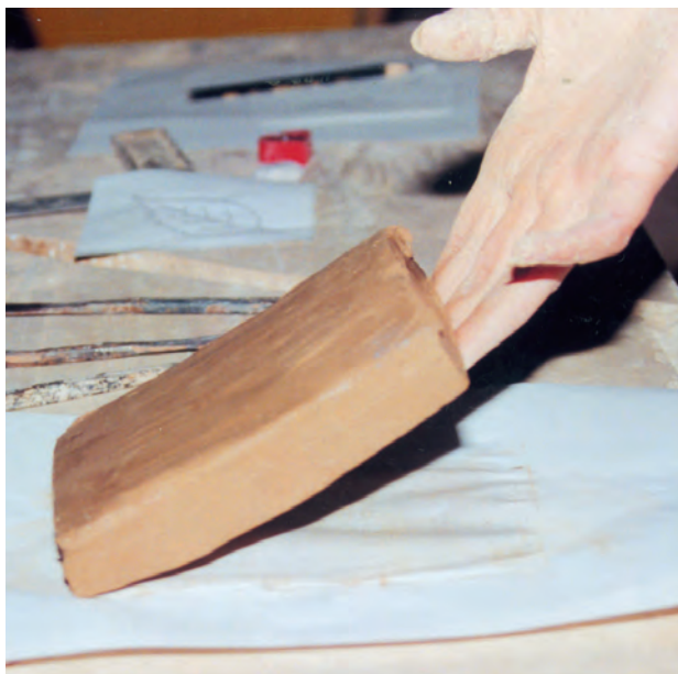
تصویر ۱- ب - مقدار رطوبت لوح برای شروع به کار مناسب است.
