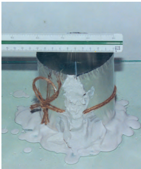
تصویر ۵- الف - اندازه گیری قطر برای محاسبه حجم قالب
