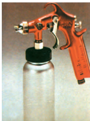
تصویر ۲۸ - پیستوله برای پاشیدن رنگ و لعاب بر بدنه
