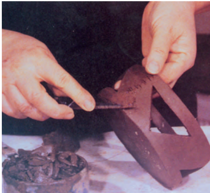
تصویر ۶-د- متصل نمودن دیواره به پایه ظرف
