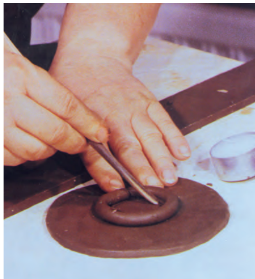
تصویر ۶-ب- ساختن پایه ظرف روی صفحه گلی
