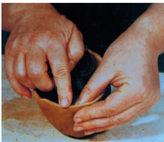
تصویر ۵-د - شکل دادن لبه‌های کاسه
