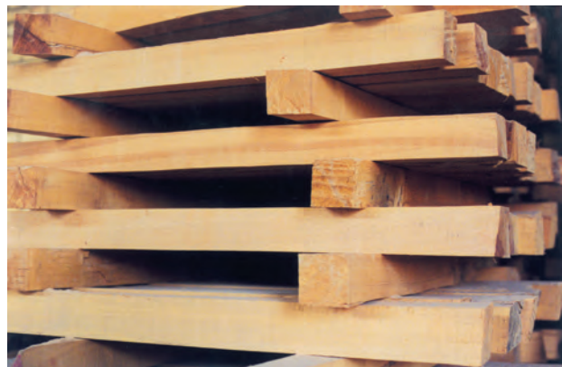
تصویر ۱۳-۱-۵- طرز چیدن تخته برای خشک کردن سنتی
