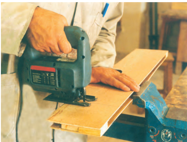
تصویر ۱-۴-۱ - روش درست بکارگیری ابزارهای برقی متحرک
