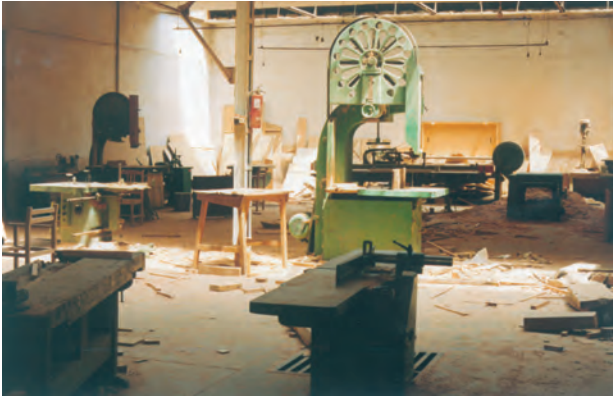
تصویر ۱-۳-۱- فضای عمومی کارگاه مقدماتی، شعاع عمل اطراف ماشین‌آلات چوب‌بری
