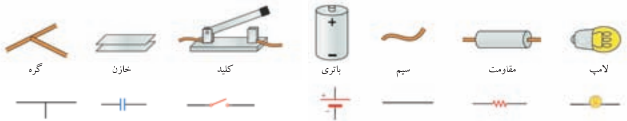
شکل ۳-۲۷ برخی از قطعه‌ها و نمادهای مربوط به آن‌ها که در اغلب مدارهای الکتریکی به کار می‌روند.
