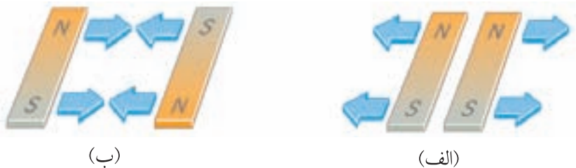
شکل ۴-۳ (الف) قطب‌های همنام یکدیگر را دفع و (ب) قطب‌های ناهمنام یکدیگر را جذب می‌کنند.
