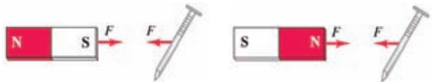
شکل ۴-۷ اطراف یک آهنربا میدان مغناطیسی وجود دارد به طوری که هر کدام از قطب‌های آن می‌توانند هر جسم آهنی مانند میخ را به سوی خود جذب کنند.
