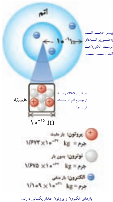
شکل ۲-۶ ساختار یک اتم، در اینجا اتم لیتیم نشان داده شده است.
