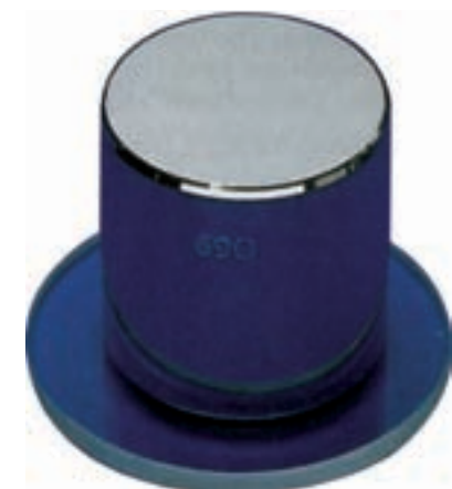
شکل ۵-۱ استاندارد بین‌المللی کیلوگرم جرم، استوانه‌ای از جنس پلاتین-ایریدیوم به ارتفاع و قطر 3/9 \text{ cm} است.
