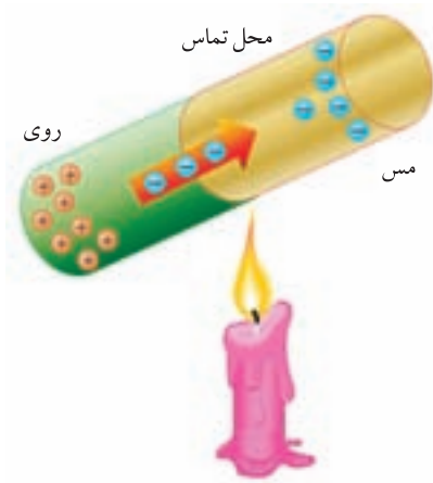
شکل ۲-۴۴ گرما سبب اختلاف پتانسیل دو سر تماس رساناها شده و در نتیجه الکترون‌ها از یک رسانا به رسانای دیگر شارش می‌کنند.
