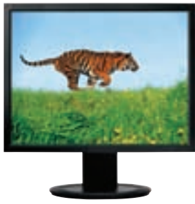
شکل ۲-۲۵ بلورهای مایع این نمایشگر (LCD) توسط میدان الکتریکی در یک امتداد قرار می‌گیرند.
