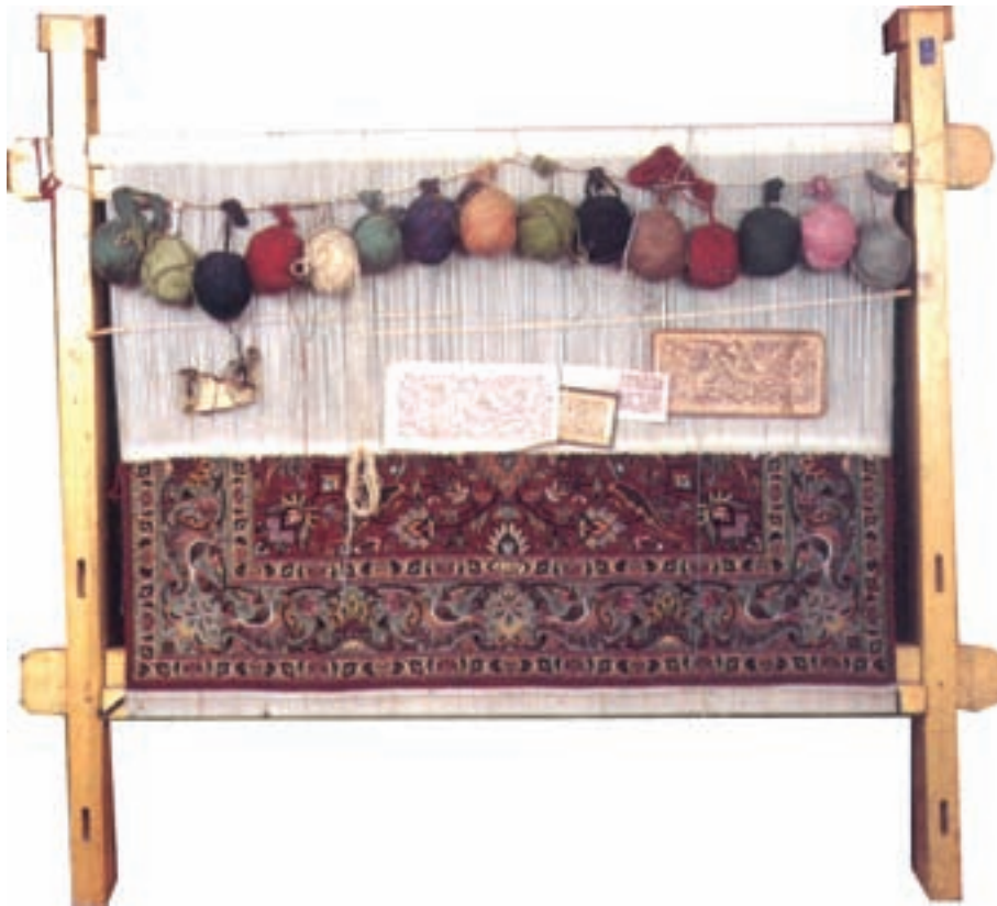
تصویر ۴-۱۲- دستگاه قالی بافی عمودی تبریزی
