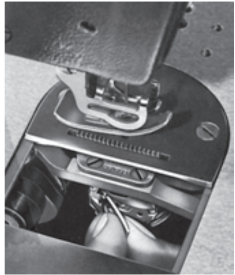
شکل ۴۸ - الف - طریقه برداشتن ماکو از زیر چرخ
