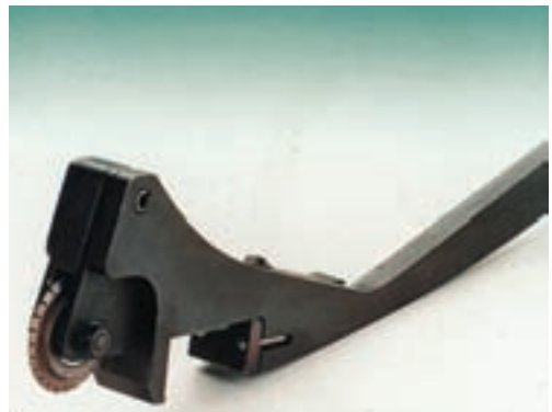
شکل ۵-۶- ابزار پرفراژ‌کاری شامل چرخ پرفراژ طولی و تیغه پرفراژ عرضی
