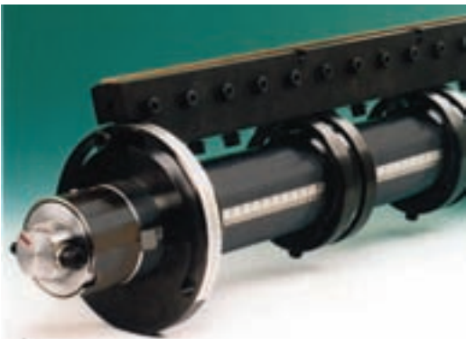
شکل ۵-۶- ابزار پرفراژ‌کاری شامل چرخ پرفراژ طولی و تیغه پرفراژ عرضی
