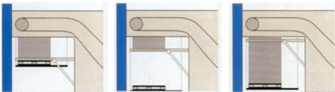
پ- تخته پالت چابی زیر دسته ورق‌ها قرار گرفته و غلتک‌ها به عقب باز می‌گردند.
