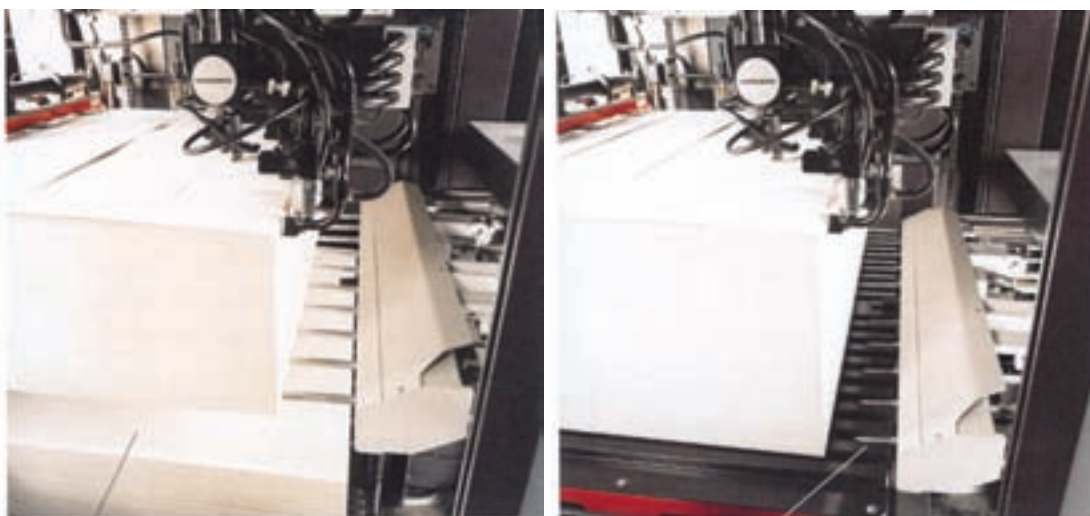
الف چنگک در زیر پالت قرار می‌گیرد (بسته ورق‌های باقی‌مانده) ب پالت جدید زیر پالت باقی‌مانده منتقل می‌شود.
