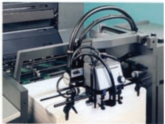
شکل ۳-۴- دماغه‌ی مکنده‌ی سیستم تغذیه‌ی پیوسته و نمای کنترل هوای دمشی و مکشی
