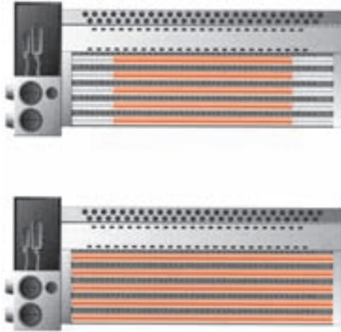
شکل ۳۹-۴- تطابق بهنای تابش اشعه نسبت به اندازه‌ی ورق چاپی
