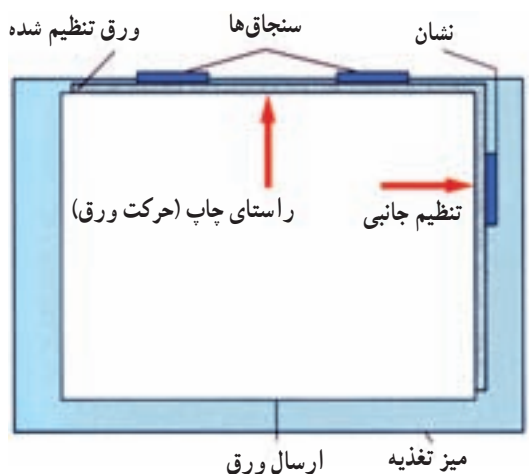
شکل ۶-۴- تنظیم راستای ورق توسط نشان و سنجاق‌ها
