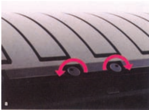
شکل ۴-۲۹- صاف کردن نیمه‌ی انتهایی ورق و تثبیت آن توسط مکنده‌های دوار سیلندر ذخیره
