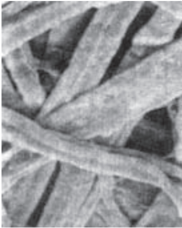
شکل ۵-۳- سلولز چوب مخروط داران با بزرگ‌نمایی ۴۲۰ برابر
