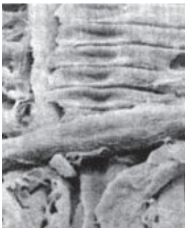
شکل ۱-۳- خمیر چوب آسیا شده با بزرگ‌نمایی ۴۲۰ برابر
