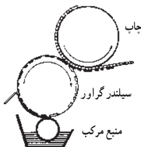
شکل ۱۴-۲- شمای یک ماشین چاپ هلیوگراور
