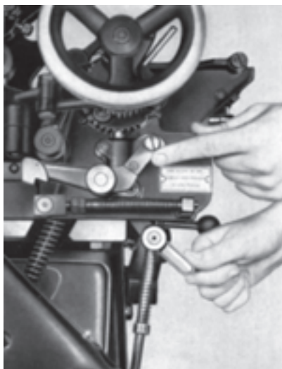
شکل ۴-۷- وصل کردن سیستم مرکب‌دهی
