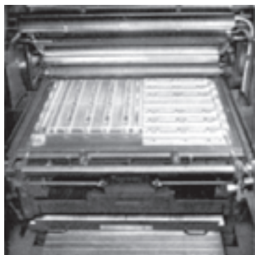
شکل ۴-۳۵- دستگاه شماره‌زنی مرکزی به صورت افقی و عمودی
