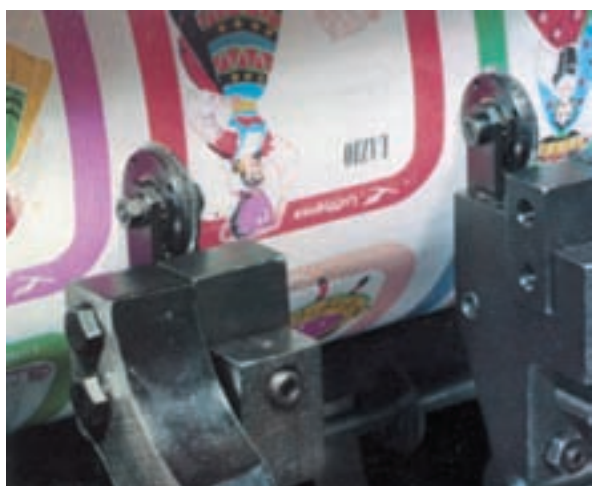
شکل ۴۵- چرخ‌های پرفراژ که با پایه روی محور بسته شده‌اند ضمن کار دیده می‌شوند.
