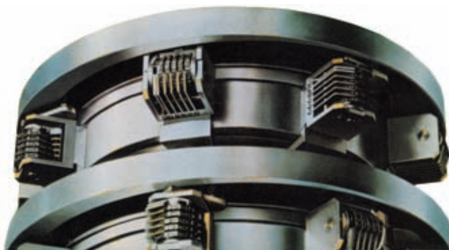
شکل ۳۹-۴ قرقره های دستگاه نمراتور مرکزی با شماره زن های افقی یا عمودی بسته شده
