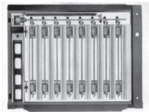
شکل ۴-۳۳- دستگاه شماره‌زنی عمودی بسته شده، کلید غلتکی سمت چپ
