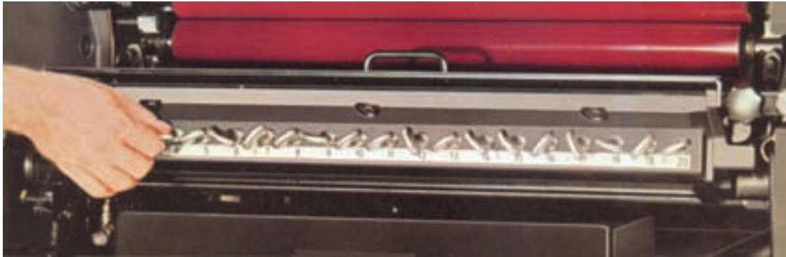
شکل ۱۱-۴ — پیچ‌های تنظیم مرکب‌دان باید به آرامی و با دقت میزان شوند.
