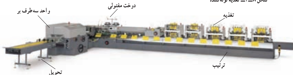
شکل ۹-۴- خط تولید مفتول دوزی، ترتیب - دوخت مفتولی
