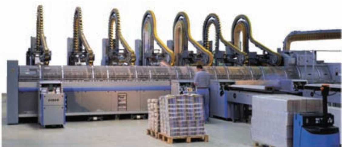
شکل ۴-۱۱- استوانه‌ی زینی دوخت مفتولی برای تولید مجله
