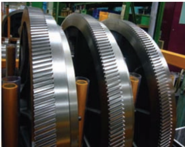
شکل ۲۱-۲- چرخ دنده‌های ویژه مورب (Helical Gear) با عمق زیاد
