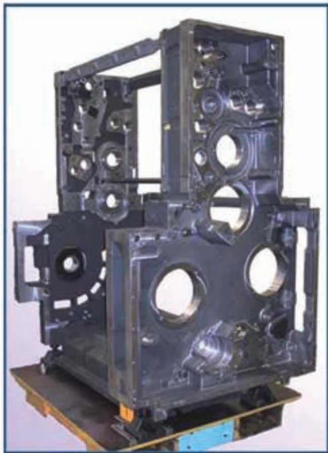
شکل ۲۲-۲- طراحی بدنه‌ی اصلی روی شاسی دستگاه
