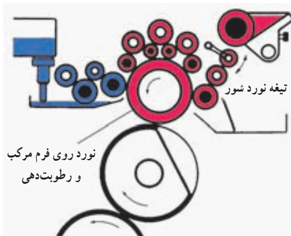
شکل ۱۰-۲- انتقال محلول رطوبت‌دهنده از طریق نورد مرکب
