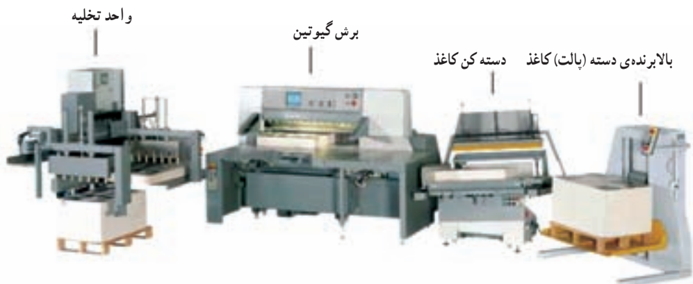
شکل ۷-۲- خط تولید برش، ورق‌های چاپ شده برای صحافی کتاب در اندازه‌ی متوسط (پولار)
