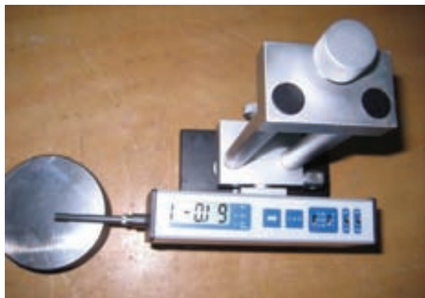
b - زبری سنج در حال اندازه‌گیری زبری
