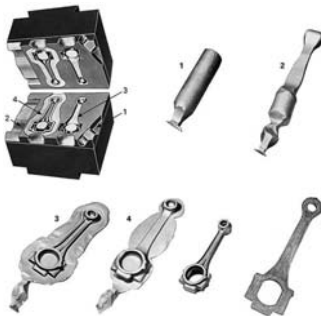
شکل ۱۰-۲- مراحل ساخت یک شاتون بوسیله قالب بسته
