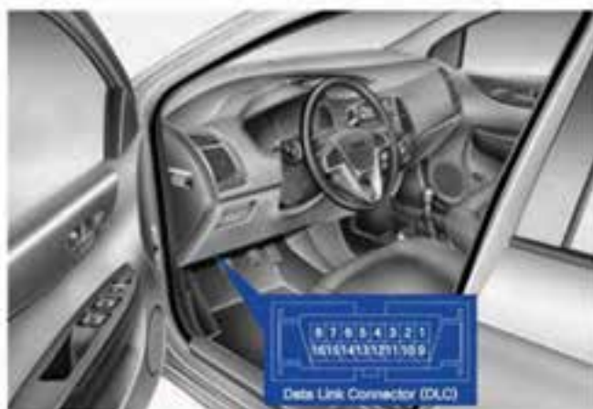
شکل ۶-۳۱- کانکتور عیب‌یابی (DLC) ۱
