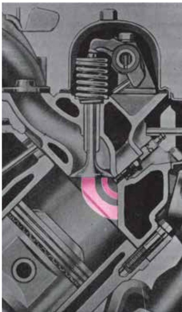
شکل ۳-۱۲- نمایش احتراق عادی که از طرف شمع شروع می‌شود.
