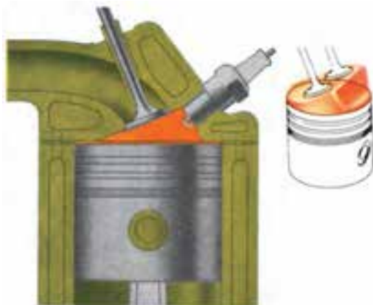
شکل ۳-۱۴- در این اتاق احتراق (گوه‌ای شکل)، شعله بهتر پیشروی می‌کند.
