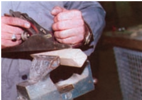
شکل ۳۰-۱۴- هشت ضلعی کردن چوب به وسیله رنده
