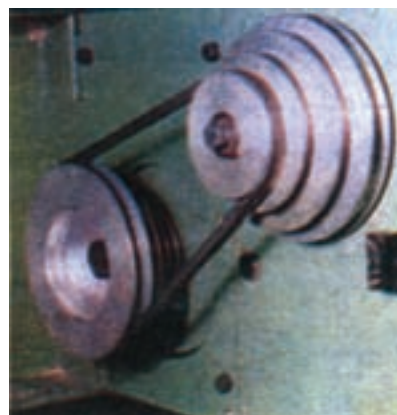
شکل ۱۴-۴۷- با جابه‌جایی تسمه دور مناسب را انتخاب کنید.
