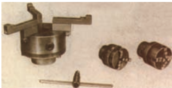
شکل ۴۰-۱۴- سه نظام و چهار نظام کله‌ای داخلی ماشین خراطی قدیمی
