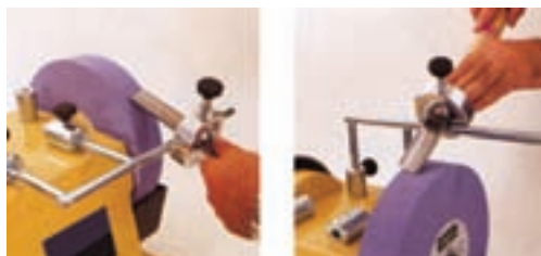
شکل ۱۴-۱۶- تیز کردن مغار خراطی با استفاده از تکیه‌گاه و شابلون
