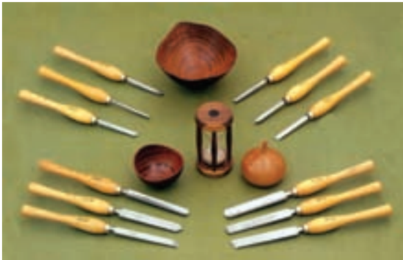
شکل ۱۲-۱۴- مغارها را طبق استاندارد بین‌المللی با دسته بلند انتخاب کنید.
