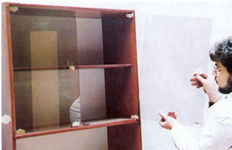
شکل ۳-۱۳- استفاده از لولای پاشنه‌ای ساده برای شیشه در کتابخانه
