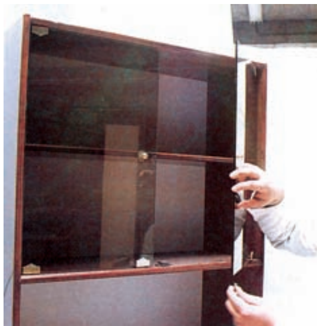
شکل ۱۱-۱۳- نحوه نصب اتصال مخصوص آهن‌ربا
