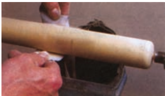
شکل ۴۵-۱۴- شماره و سختی سنباده را متناسب با سطح کار انتخاب کنید.
