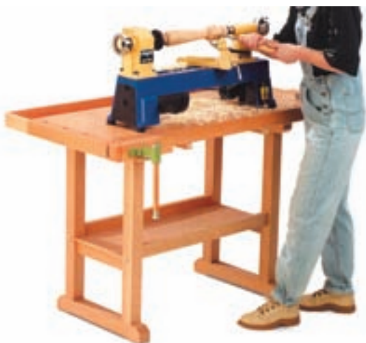
شکل ۳-۱۴- نحوه کار کردن با ماشین خراطی رومیزی
