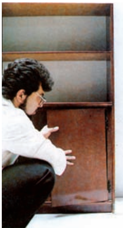
شکل ۸-۱۳- جاسازی و علامت‌گذاری برگه لولای روی کار
