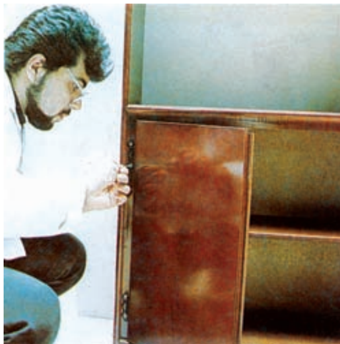
شکل ۹-۱۳- نصب در با پیچ گوشتی توسط دانشجوی رشته صنایع چوب مرکز آموزش عالی فنی انقلاب اسلامی
