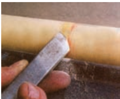
شکل ۱۴-۲۶- صاف و یکنواخت کردن سطح استوانه
