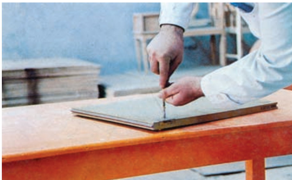
شکل ۷-۱۳- نصب یک عدد قفل سوئیچی
