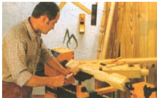
شکل ۱۷-۱۴- محور قطعه کار را موقع خراطی در امتداد محور مرگکها قرار دهید.
