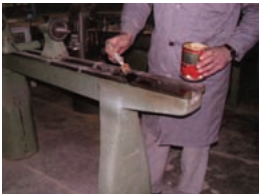
شکل ۱۴-۴۹- آغشته به نفت کردن بستر ماشین خراطی
