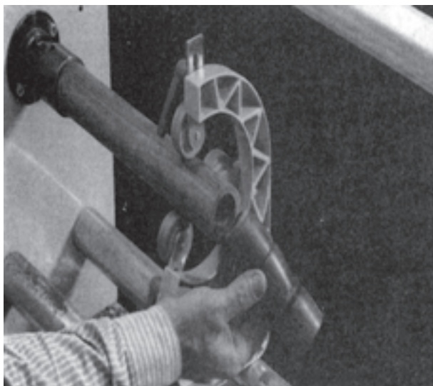
شکل ۳۳-۱۴- استفاده از تکیه‌گاه سه چرخ برای خراطی چوب‌های بلند
