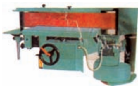
شکل ۱۳-۱۲- سنباده نواری کوچک به اندازه ۱۵۵×۱۸۰ میلی متر
