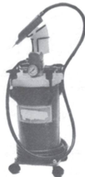
شکل ۹-۱۰- مخزن چسب مایع با پیستوله چسب زنی
