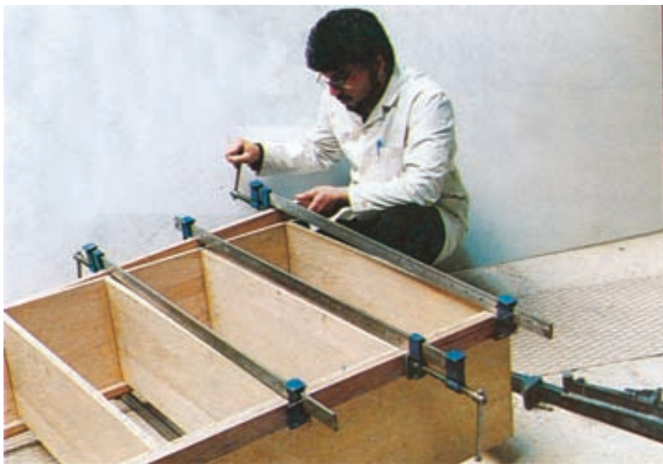
شکل ۱۱-۲۳- نحوه استقرار چوب بین سطح کار و تنگ و محکم کردن تنگ در عملیات مونتاژ کاری
