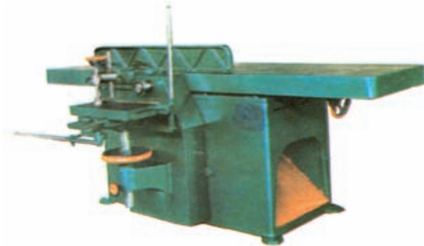
شکل ۳۰-۹- ماشین دوکاره رنده و مته
