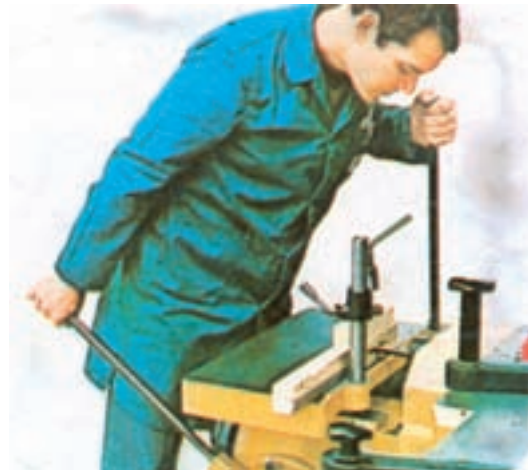
شکل ۹-۶۴- نحوه استقرار هنر جو در عملیات کام کنی
