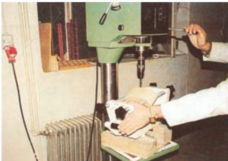
شکل ۹-۶۰- استفاده از فیکسچر اختصاصی در عملیات سوراخکاری قطعات نامنظم
