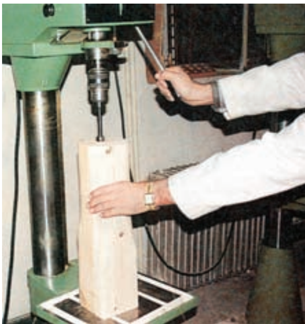
شکل ۹-۵۶- سوراخکاری قطعه بلند عمودی
