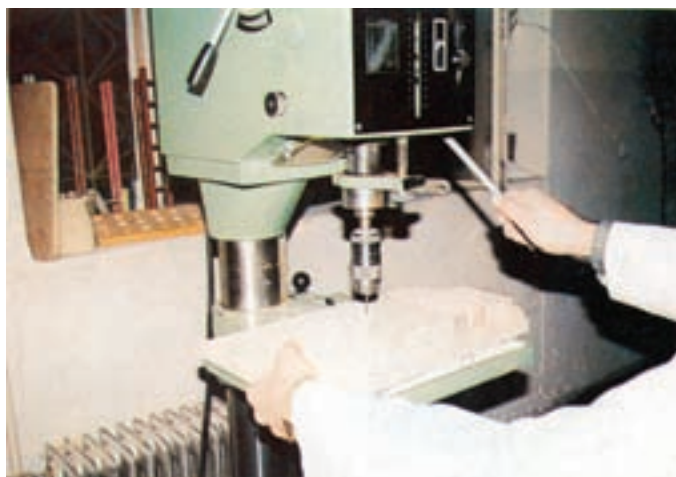
شکل ۹-۵۳- استفاده از صفحه کمکی زیر صفحه اصلی در سوراخکاری دوطرفه
