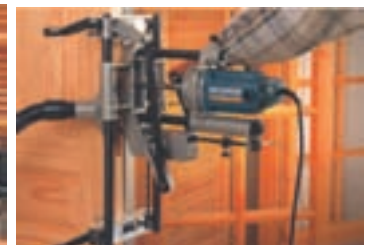
شکل ۷۸-۹- ایجاد شیار عمودی برای قفل مغزی
