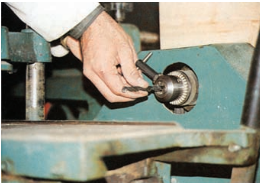
شکل ۹-۳۵- نحوه قرار دادن مته در سه نظام و محکم کردن آن
