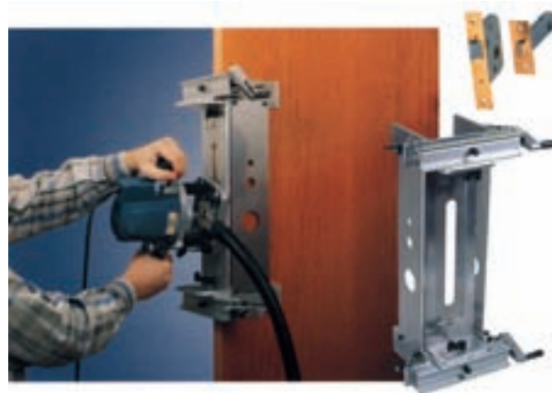
شکل ۹-۷۴- شیار زدن جای مغزی قفل با استفاده از شابلون
