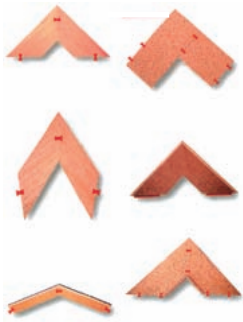
شکل ۹۳-۹ اتصال دم چلچله در قطعات با زوایای مختلف
