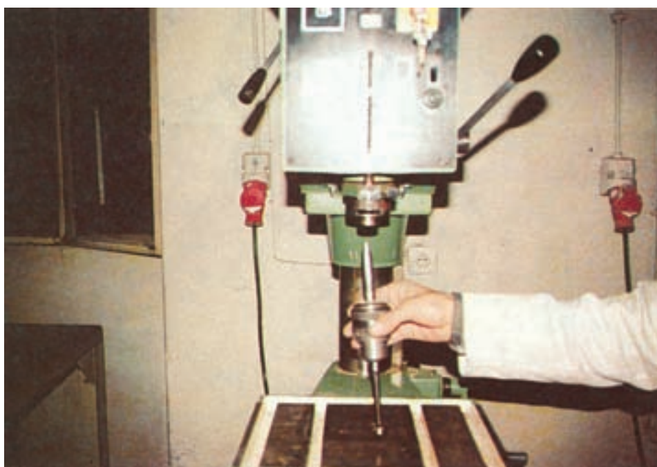
شکل ۲۶-۹- نحوه خروج دنباله مخروطی از کلاهک محور و کنترل آن
