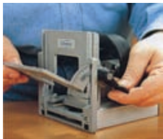
شکل ۹-۱۱۰- نحوه تنظیم زاویه گونیا
