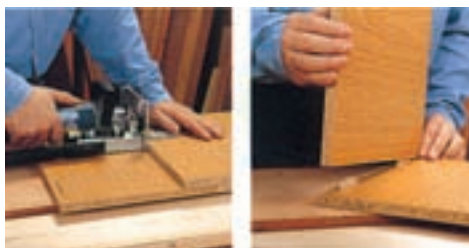
شکل ۹-۱۱۱- نحوه استفاده از گونمای ۹۰° دستگاه در اتصال دو صفحه
