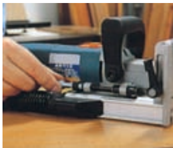
شکل ۹-۱۰۹- نحوه تنظیم عمق تیغه
