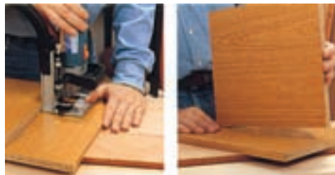
شکل ۹-۱۰۶- اتصال بیسکوییتی در دو صفحه به صورت 90^\circ ساده
