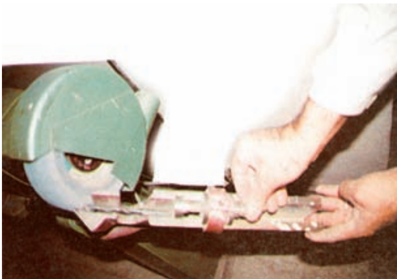
شکل ۵۱-۹- نحوه تیز کردن مته ماریج با ماشین سنگ سنباده با کمک مقر مته
