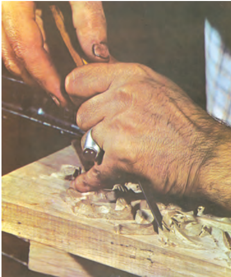
شکل ۲۴-۶- نحوه‌ی ضربه‌زدن با چکش به انتهای مغار شکل ۲۵-۶- نحوه‌ی کار با مغار در اجرای طرح اصلی
