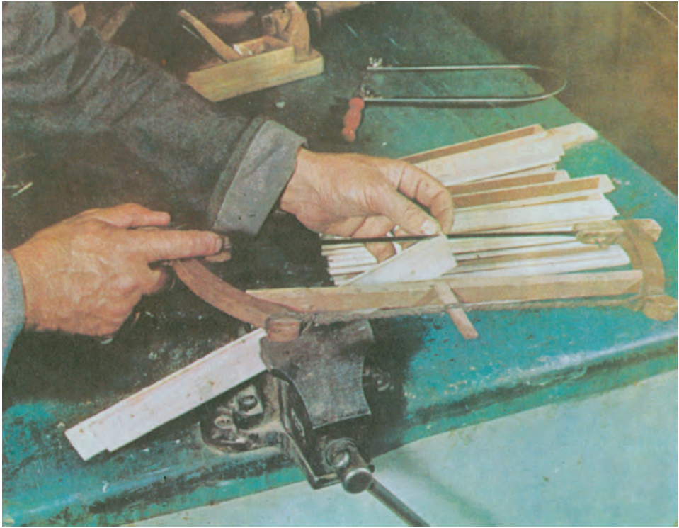
شکل ۱۷-۶- نحوه‌ی برش خاتم آسترشده
