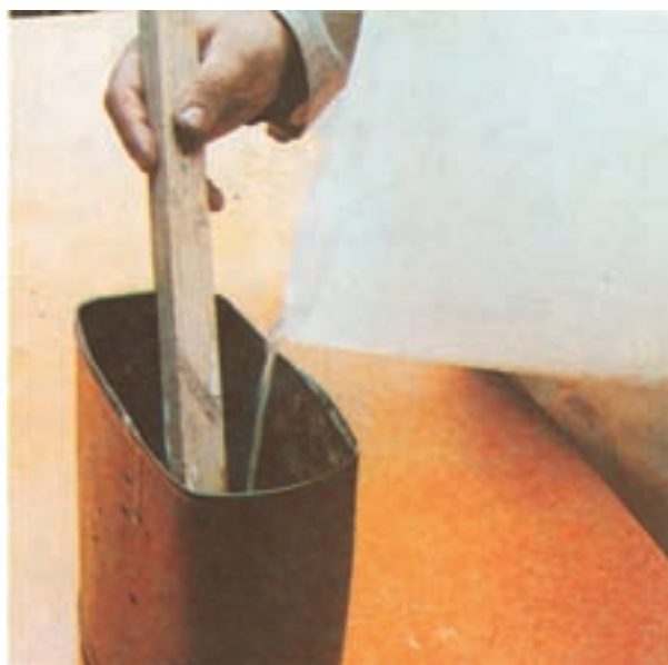
شکل ۶-۷- مخلوط کردن مایع سخت کننده با مایع چسب
