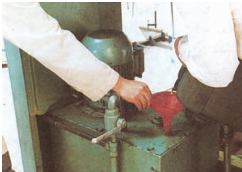
شکل ۱۷-۷- ریختن روغن هیدرولیک داخل کارتر
