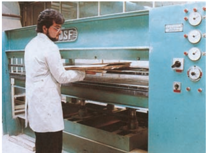
شکل ۲۴-۷- دانشجوی رشته صنایع چوب در حال استقرار صفحه روکش زیر پرس
