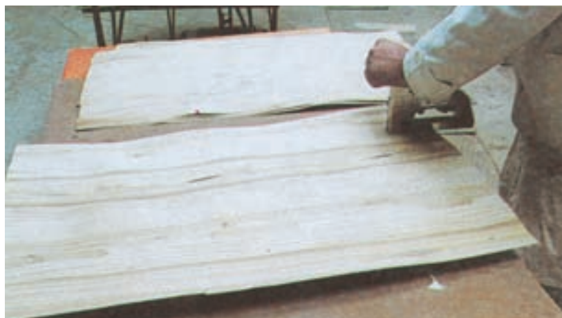
شکل ۷-۱۳- نحوه استفاده از دستگاه دوخت برای ثابت کردن روکش روی سطح کار
