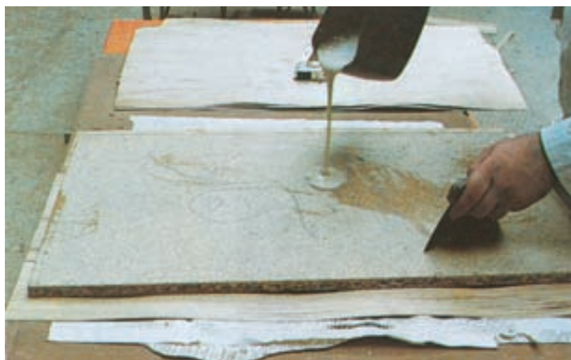
شکل ۷-۱۴- زیر صفحه روکش شده قبلی کاغذ پهن کنید.
