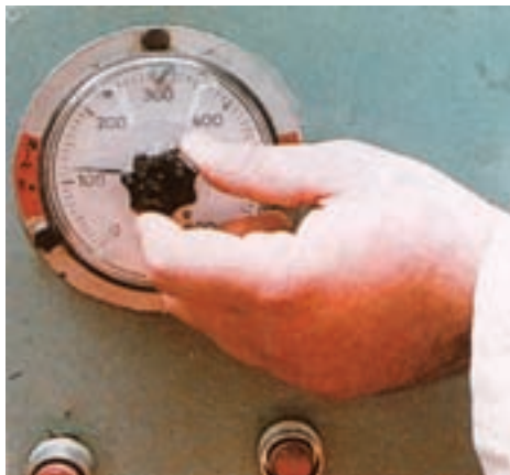
شکل ۷-۲۳- نحوه تنظیم فشار سنج پرس
