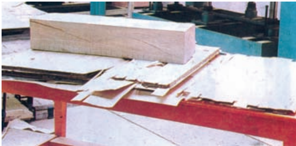
شکل ۳۱-۷ گذاشتن وزنه روی سطح کار روکش شده داغ
