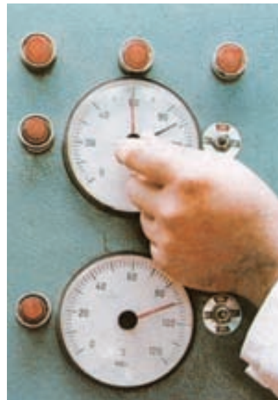
شکل ۷-۲۱- نحوه تنظیم حرارت سنج پرس
