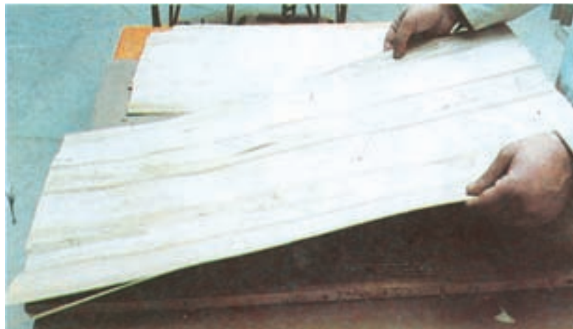
شکل ۷-۱۲- استقرار روکش روی سطح چسب زده شده
