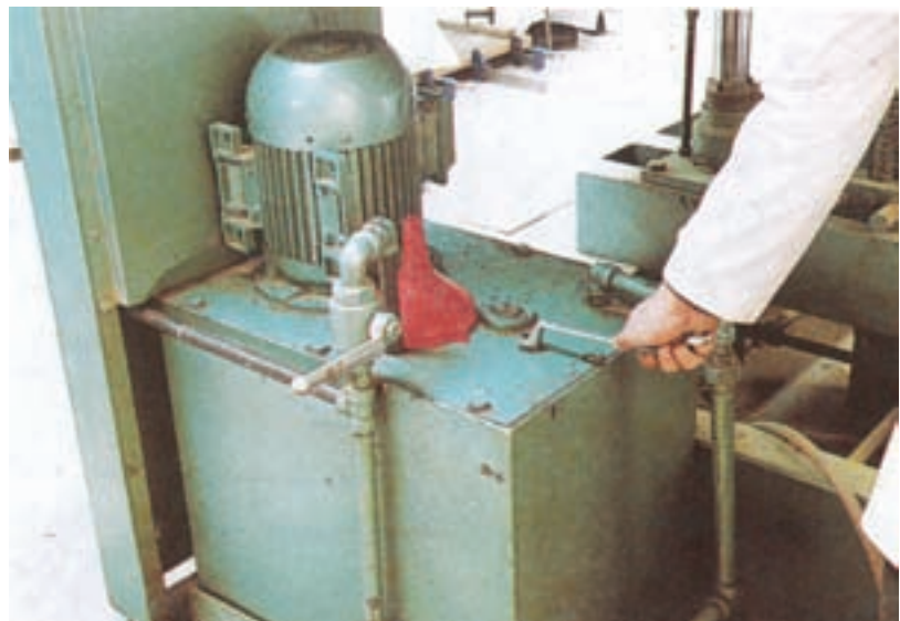
شکل ۷-۱۶- نحوه باز کردن و آزمایش کردن میزان روغن کارتر
