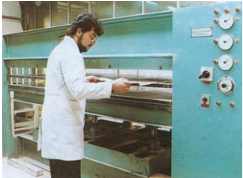
شکل ۷-۱۵- صفحات پرس را تمیز کنید و روی آن کاغذ بپهن نمایید.
