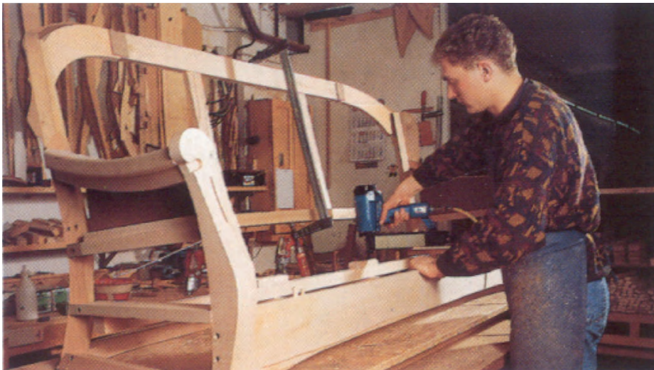
شکل ۵-۶۹- آماده سازی کلاف برای نوارکشی و فتر بندی
