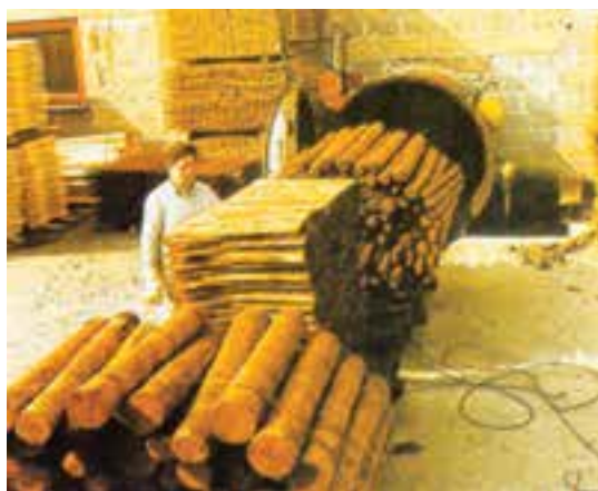
شکل ۴-۶- چوب‌های مختلف آماده برای اشباع
