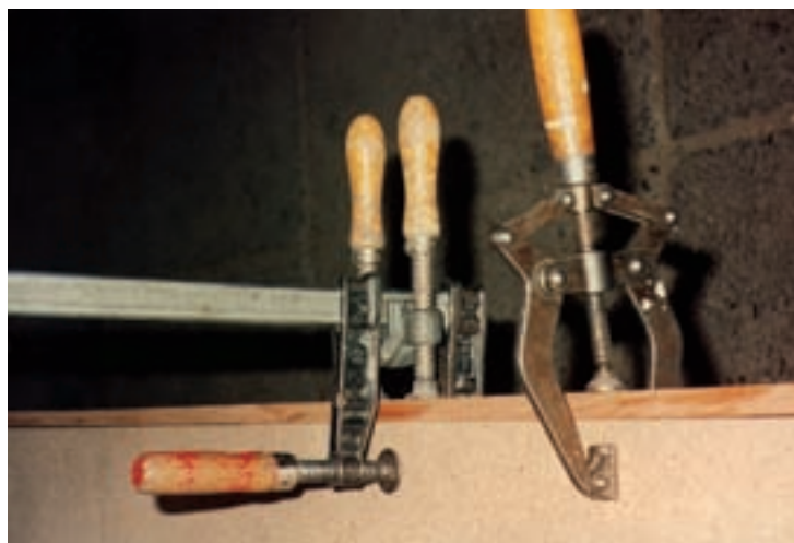
شکل ۱۰-۶- انواع گیره یا پیچ دستی و تنگ
