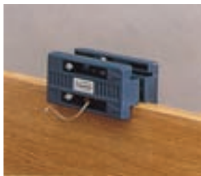
شکل ۲۴-۶- رنده دوطرفه لبه‌های اضافی نوار
