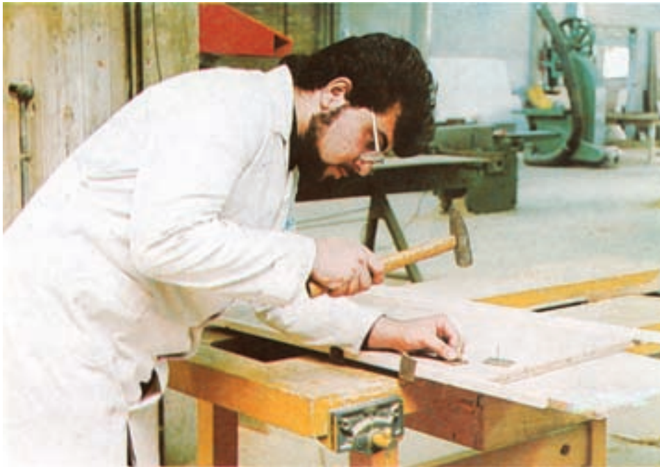
شکل ۶-۷- تهیه قطعات کوچک فیبر و میخ برای عملیات چسباندن زهوار
