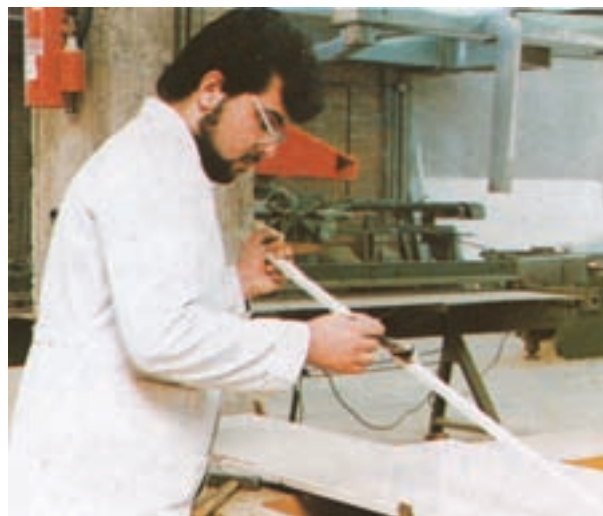
شکل ۶-۴ چسب زدن زهوار چوبی به وسیله قلم مو
