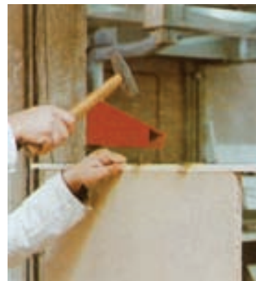
شکل ۸-۶- عمل زهوار کوبی عرض صفحه با فیبر میخ دار
