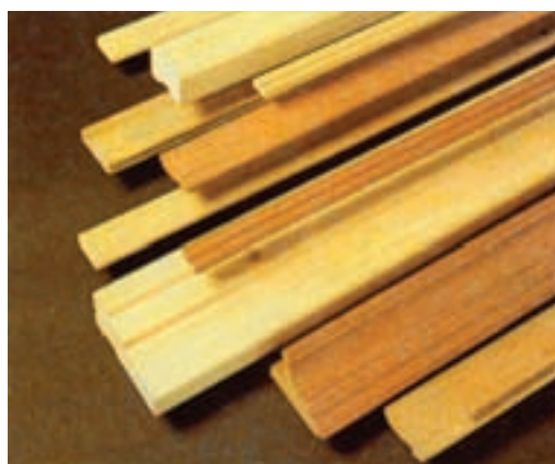
شکل ۶-۱- زهوارهای پروفیل زده شده
