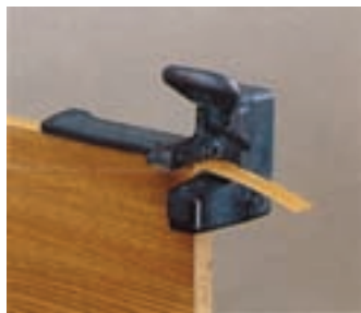
شکل ۲۵-۶- گیوتین برای قیچی کردن لبه اضافی
