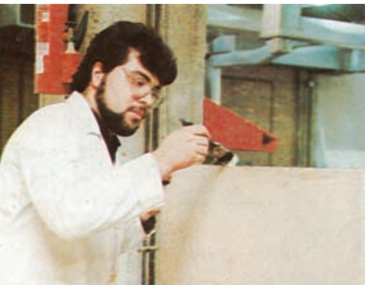
شکل ۶-۶ چسب زدن ضخامت صفحه تخته خرده چوب
