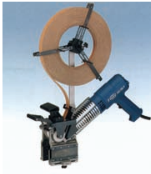
شکل ۲۱-۶- دستگاه لبه چسبان با دهانه قابل تنظیم برای ضخامت‌های مختلف
