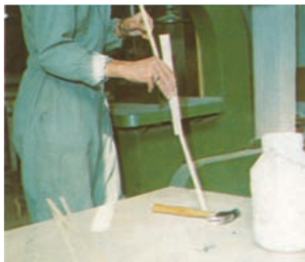
شکل ۶-۵ چسب زدن زهوار به وسیله یک قطعه چوب
