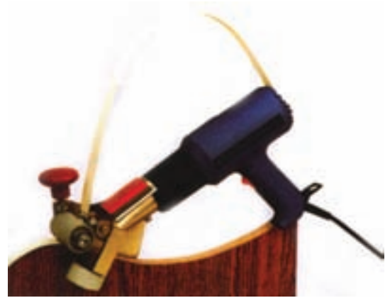
شکل ۱۷-۶- لبه چسبان دستی برای سطوح صاف و منحنی
