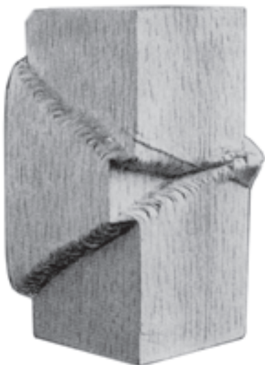
شکل ۹-۱ — شکست چوب در اثر نیروهای فشاری
