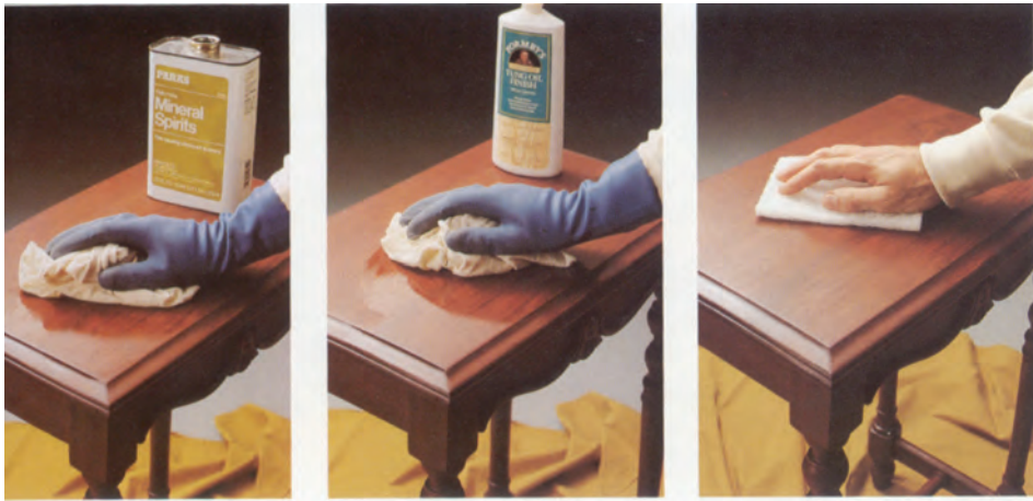
شکل ۱۲-۵- واکس زدن با پارچه
