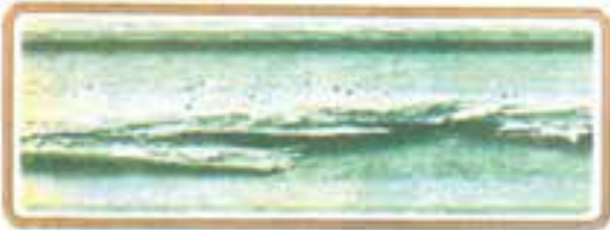
اثر تخریب این نوع سوسک‌ها در چوب پهن‌برگ
