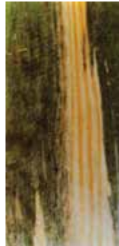
شکل ۸-۵- چوب آلوده به پوسیدگی آبی
